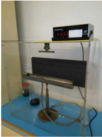
Obrázek č. 2 - Přístroj na měření vztlínivosti (foto + schéma) [8]
