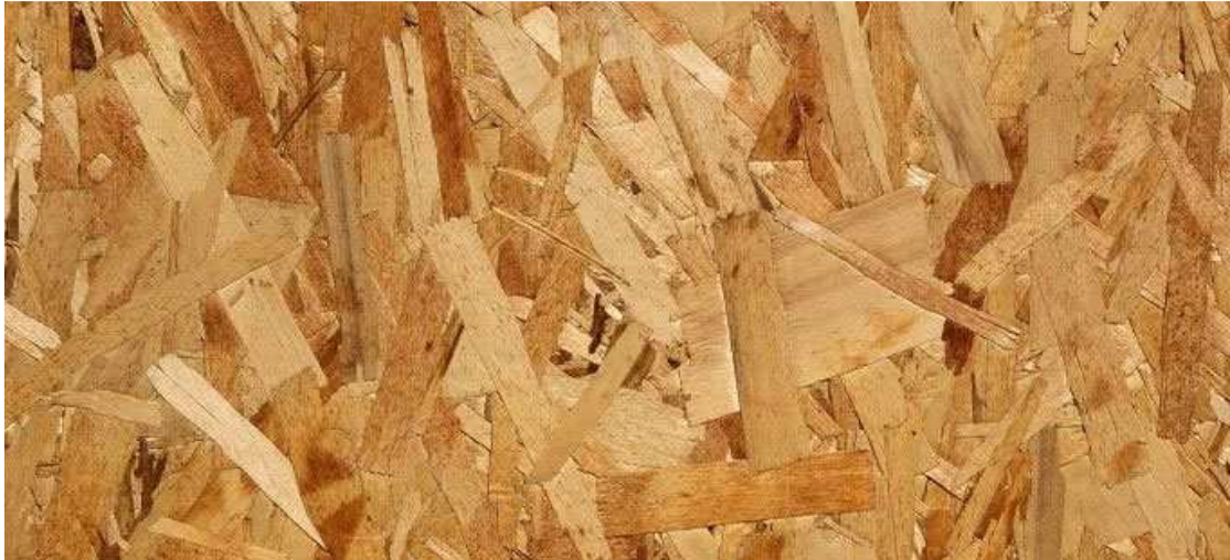
Obr. 5 Třísky OSB desky (lamimorava.cz)
