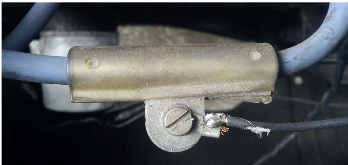
Obr.6: Detail možného provedení sondy na zapalovacím kabelu
