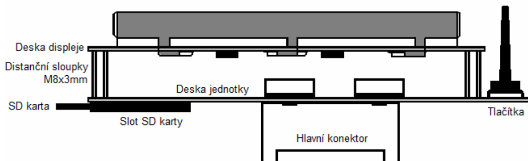
Obr. 10: Náčrtek mechanické konstrukce (rozměry neodpovídají skutečnosti)
