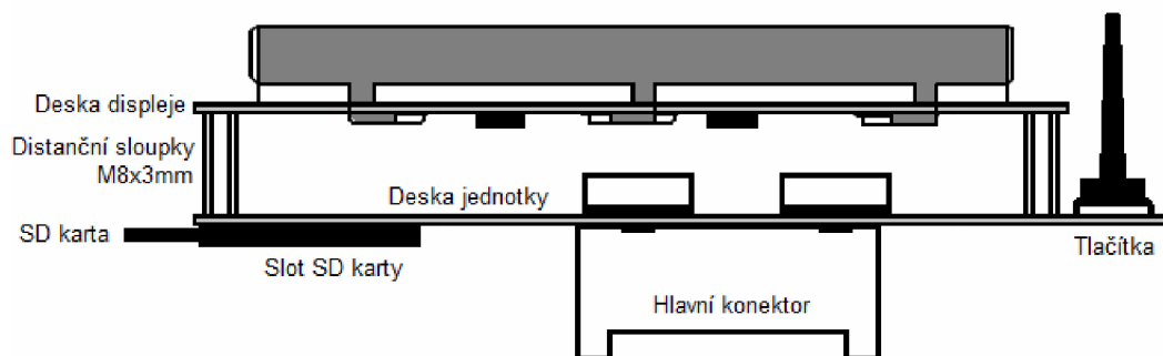
Obr. 10: Náčrtek mechanické konstrukce (rozměry neodpovídají skutečnosti)
