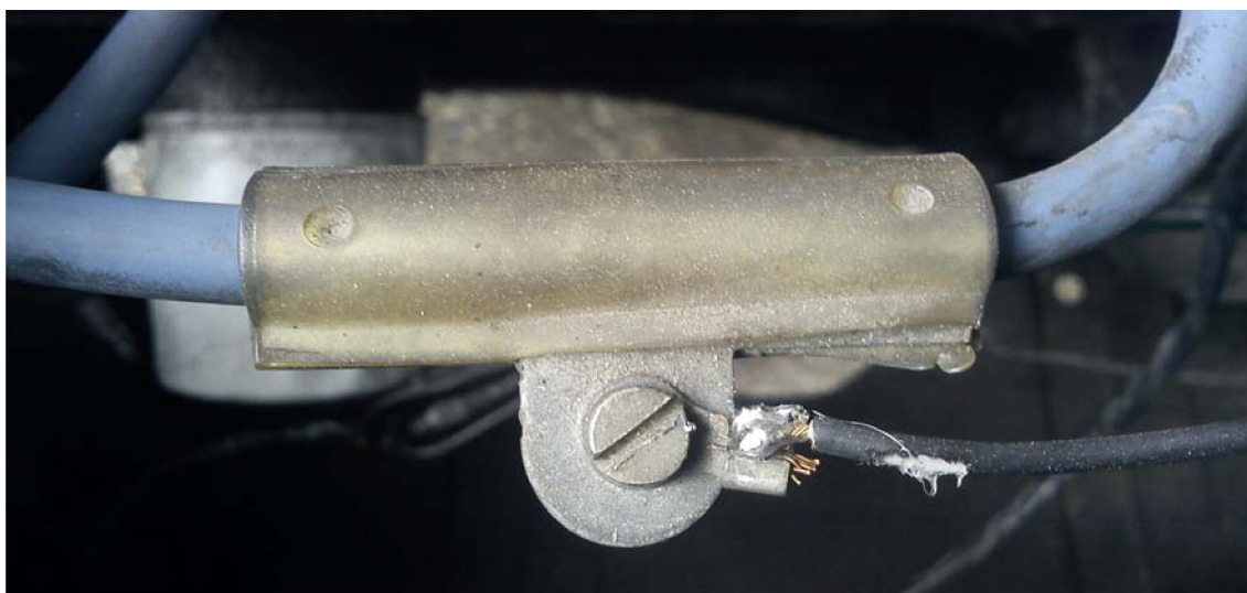
Obr.6: Detail možného provedení sondy na zapalovacím kabelu
