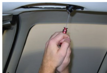
Obr. 16 – Uložení aktivační rukojeti na letounu CIRRUS (zdroj [18])
