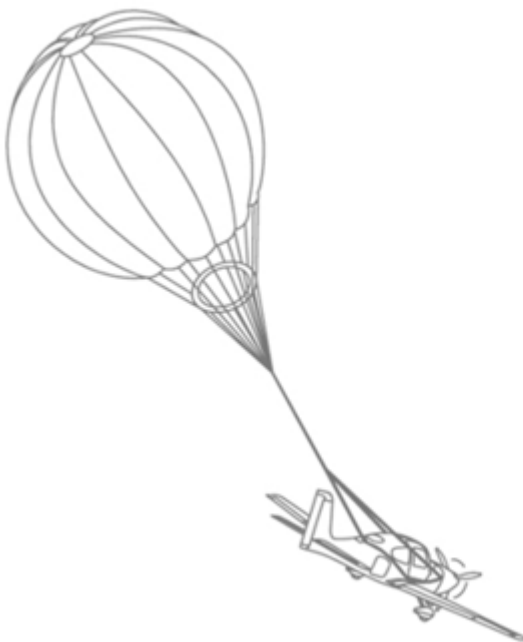
Obr. 19 – Sled událostí po výstřelu CAPS systému na letounu CIRRUS (zdroj[20])
