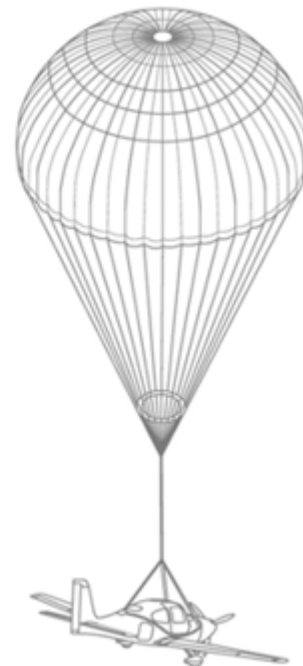
Obr. 19 – Sled událostí po výstřelu CAPS systému na letounu CIRRUS (zdroj[20])
