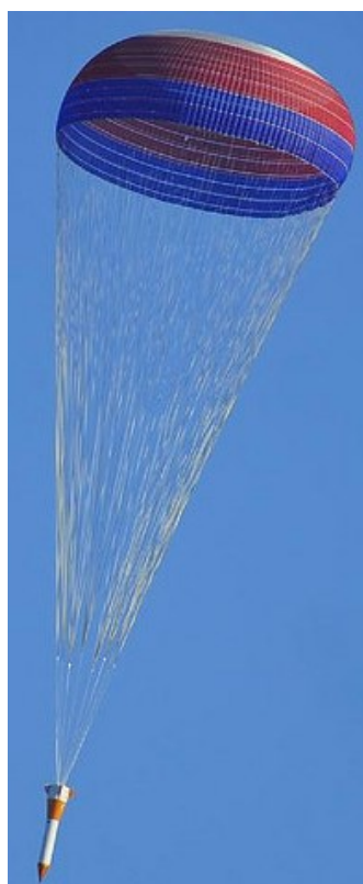
Obr. 11 – Polosférický padák s hustou sítí lanek (zdroj [22]) a Obr. 12 – Polosférický padák se stabilizujícím padákem (zdroj [23])
