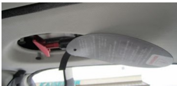
Obr. 16 – Uložení aktivační rukojeti na letounu CIRRUS (zdroj [18])
