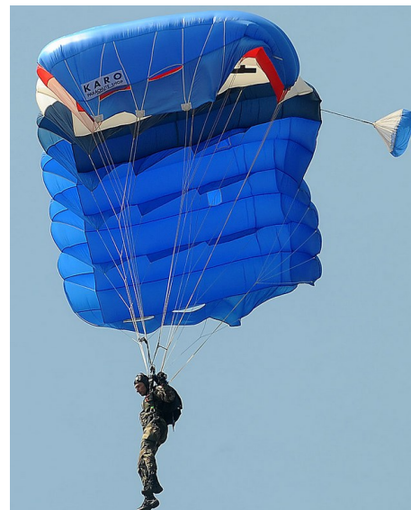
Obr. 7 – Polosf.padák se sliderem (zdroj [11]) Obr. 8 – Padák typu křídlo (zdroj [12])
