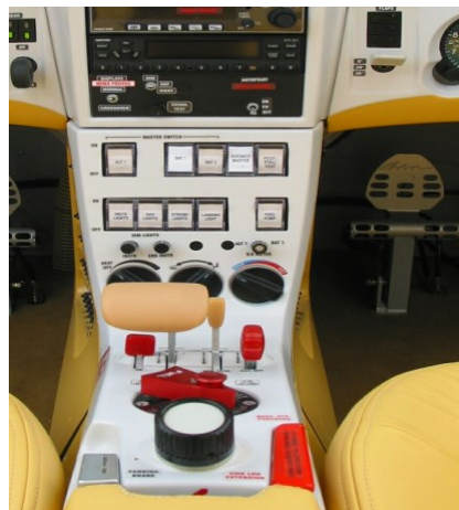
Obr. 34 – Možnost umístění instalace aktivační páky – mezi sedadly pilotů (zdroj [22])
