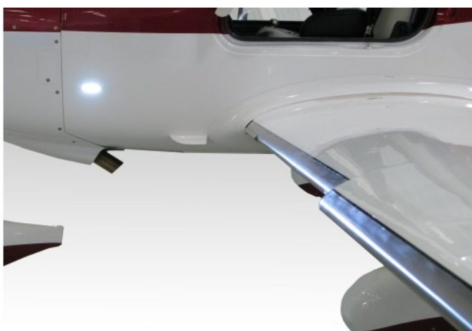
Obr. 4 – TKS-Ice Protection system na letounu Cirrus (zdroj [9])
