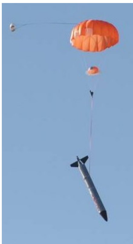
Obr. 11 – Polosférický padák s hustou sítí lanek (zdroj [22]) a Obr. 12 – Polosférický padák se stabilizujícím padákem (zdroj [23])
