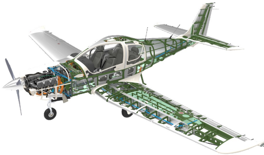
Obr. 20 – Prezentační obrázek s řezem konstrukcí letounu VUT100 Cobra (zdroj[22])
