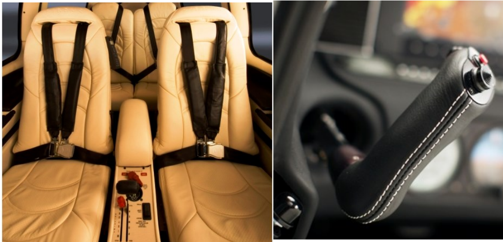
Obr. 5 a Obr. 6 – Airbagy a sidestickové ovládání řízení na letounu Cirrus (zdroj 10j)
