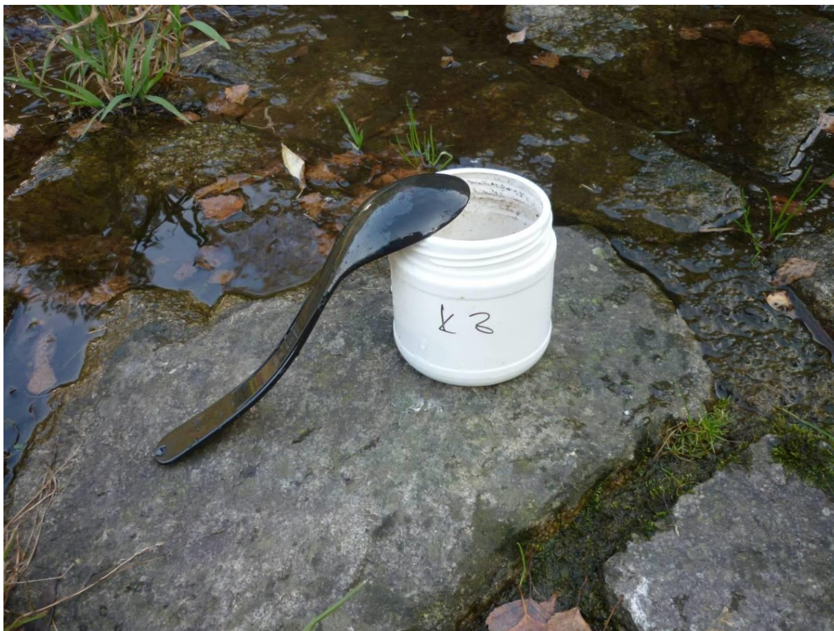
Obr. 15: PE vzorkovnice s odběrovou lžící (Foto: Jakešová, 2011)
