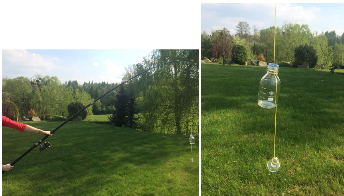
Obr. 16: Odběrová tyč se vzorkovnicí a závažím (foto Jakešová 2015).
