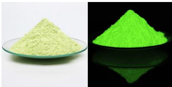
Obr. 15. Fotoluminiscenční pigment před a po excitaci [9][10]
