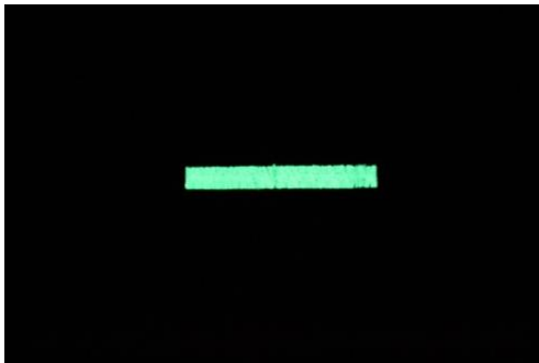
Obr. 47. Fotografie vzorku výšivky s fotoluminiscenční nití N102 při luminiscenci po jedné minutě
