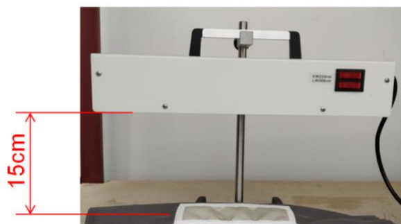
Obr. 38. Širokopásmová UV lampa nad měřeným vzorkem
