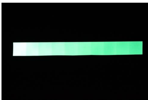
Obr. 56. Fotografie vzorku fotoluminiscenční folie po dvou minutách od nasvícení
