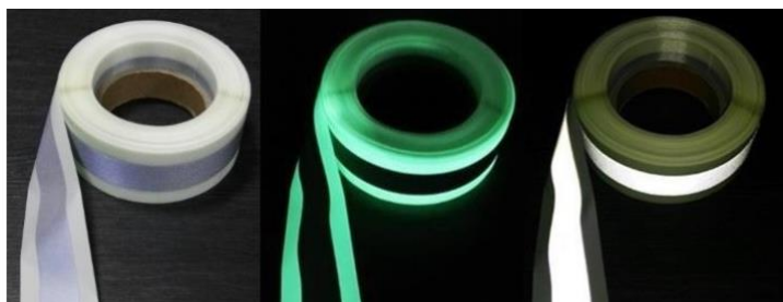
Obr. 17. Fotoluminiscenční reflexní páska během denního světla, při luminiscenci a retroreflexi [14]
