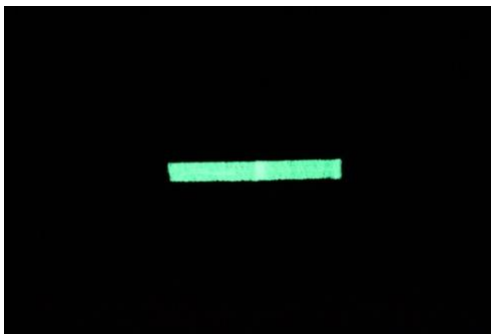
Obr. 51. Fotografie vzorku výšivky po prání s fotoluminiscenční nití N102 při luminiscenci po jedné minutě
