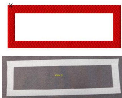
Obr. 33. Navržené tvarové vyšívání luminiscenčního vzoru 3 a jeho praktická realizace
