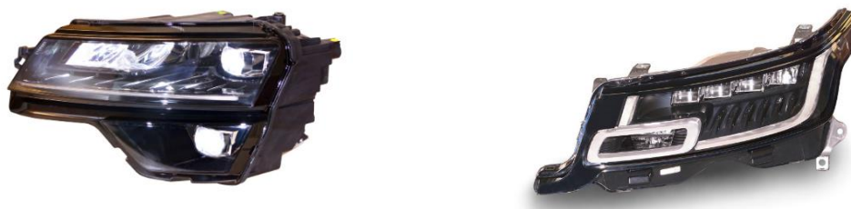
Obrázek 1: Typy světlometů: vlevo – LED s adaptivním osvětlováním vozovky, vpravo – laserový; převzato z [4]
