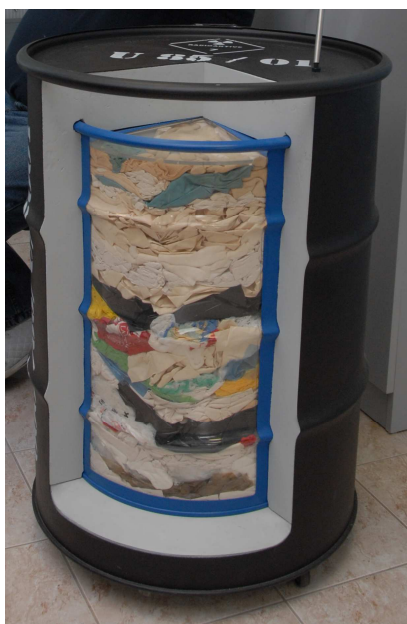
Obrázek 5: Model standardní obalové jednotky radioaktivního odpadu
