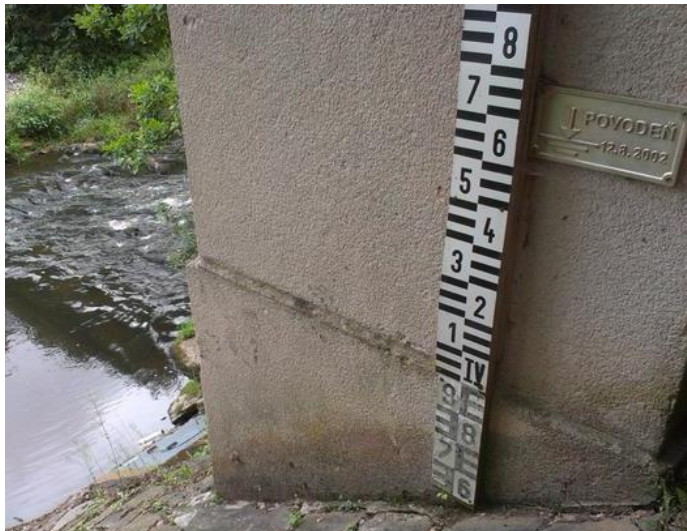
Obrázek č. 2.12: Vodočetná lať (www.d34-a.sdn.cz)
