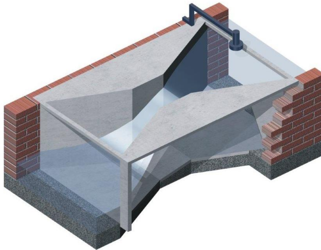
Obrázek č. 2.4: Parshallův žlab ( www.pars-aqua.cz )
