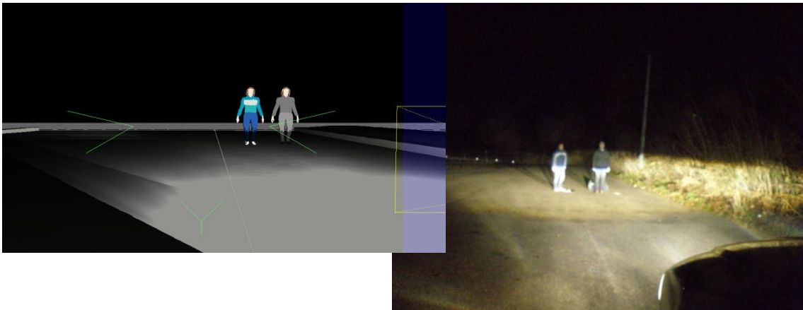
Obrázek 59: Pohled na figuranty v tmavém a běžném oblečení (vzdálenost 10m, potkávací světla). Zdroj vlastní.
