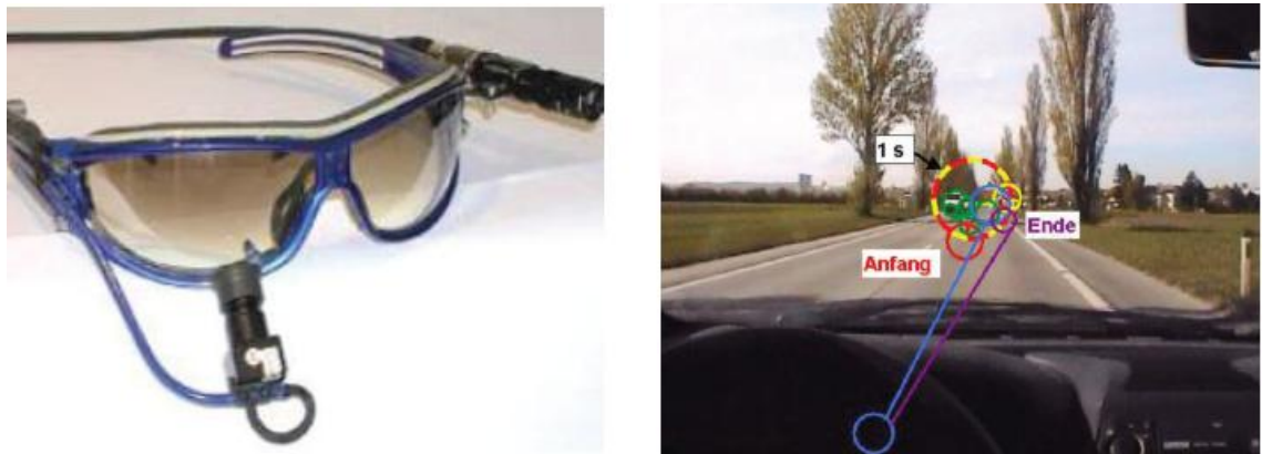
Obrázek 13: ViewPoint systém pro hodnocení vizuální pozornosti řidiče.
