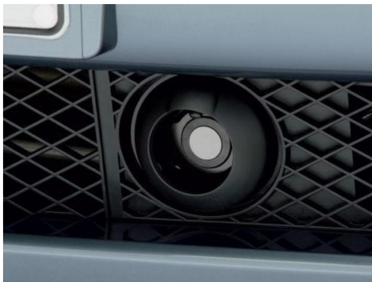
Obrázek 16: Umístění infračervené kamery na vozidle.
