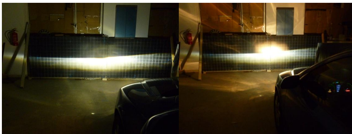
Obrázek 23: Měření levého světlometu na rastru (vlevo potkávací světlo, vpravo dálkové světlo).
