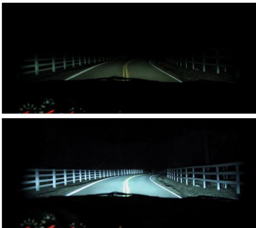
Obrázek 1: Rozdíl mezi osvětlením vozovky halogeny a xenony.
