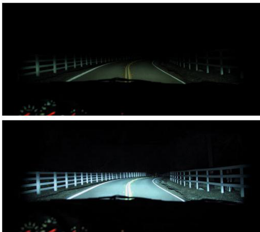
Obrázek 1: Rozdíl mezi osvětlením vozovky halogeny a xenony.
