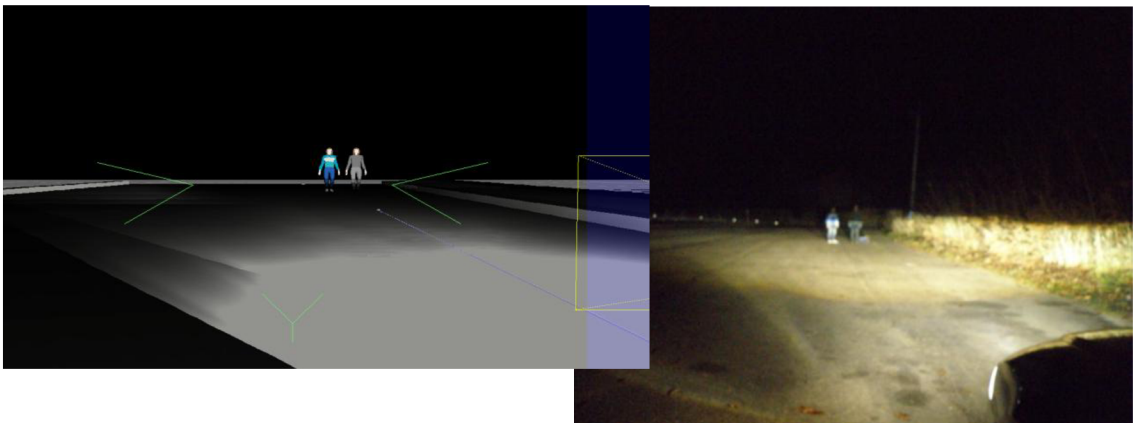
Obrázek 56: Pohled na figuranty v tmavém a běžném oblečení (vzdálenost 20m, potkávací světla).
