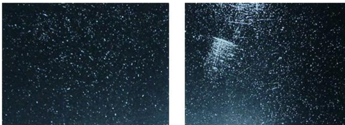
Obrázek 10: Rozptýlené světelné obrazy na rozdílných čelních sklech.
