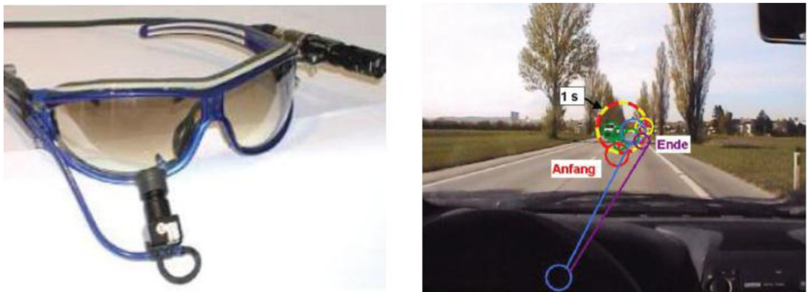
Obrázek 13: ViewPoint systém pro hodnocení vizuální pozornosti řidiče.
