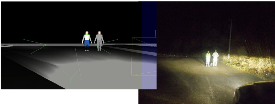
Obrázek 60: Pohled na figuranty v bílém a reflexním oblečení (vzdálenost 10m, potkávací světla).
