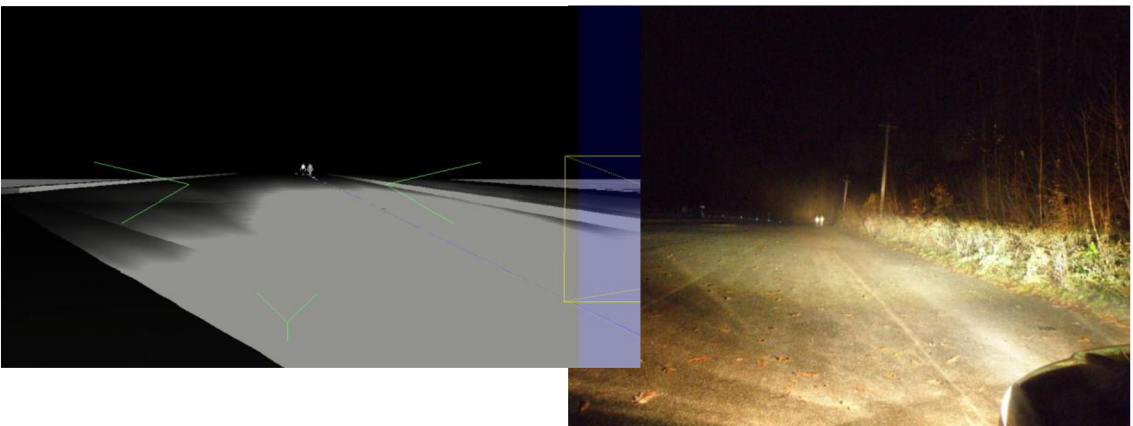
Obrázek 69: Pohled na figuranty v bílém a reflexním oblečení (vzdálenost 80m, dálková světla).
