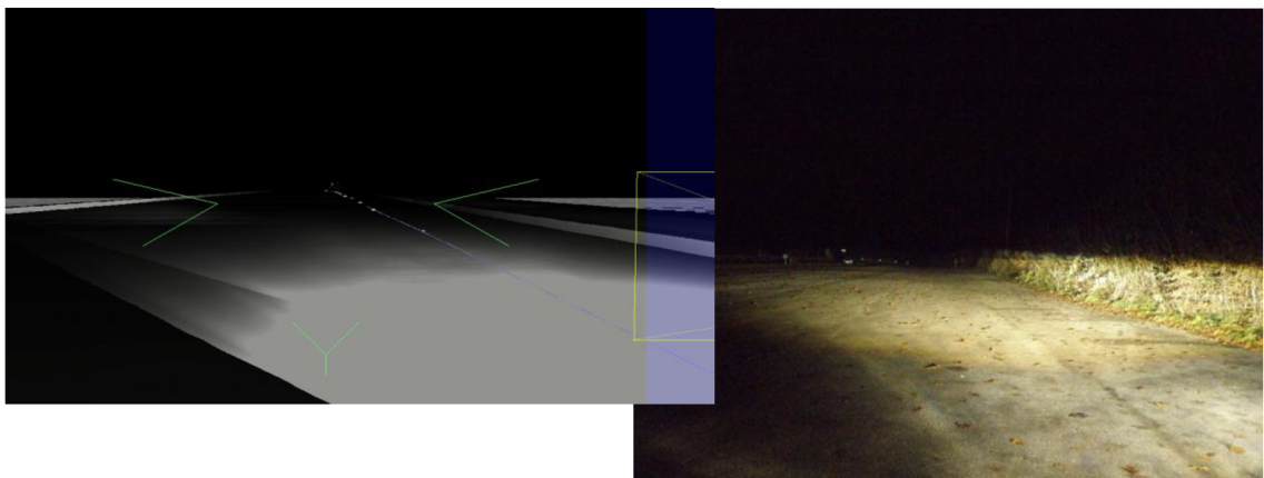
Obrázek 32: Pohled na figuranty v tmavém a běžném oblečení (vzdálenost 100m, potkávací světla).
