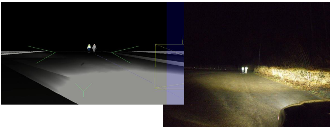
Obrázek 54: Pohled na figuranty v bílém a reflexním oblečení (vzdálenost 30m, potkávací světla).
