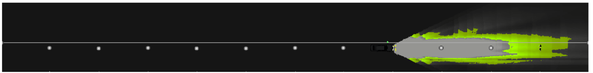
Obrázek 82: Pohled shora na měřicí úsek (vzdálenost 30m, dálková světla).
