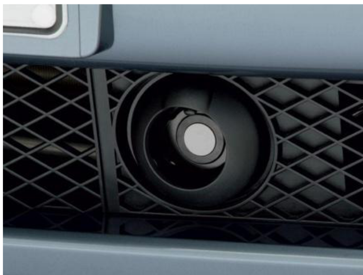
Obrázek 16: Umístění infračervené kamery na vozidle.
