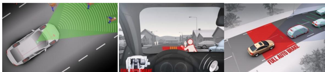
Obrázek 17: Ukázka funkce systému Volvo Pedestrian Detection.
