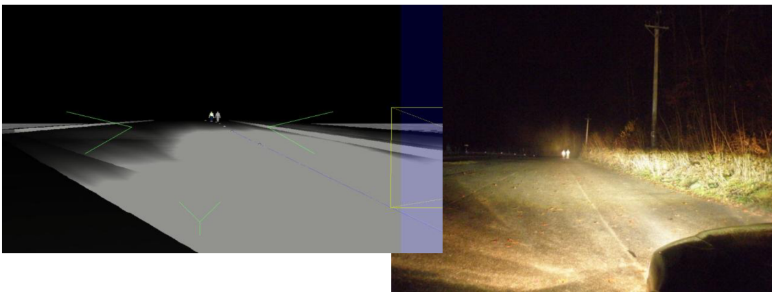
Obrázek 75: Pohled na figuranty v bílém a reflexním oblečení (vzdálenost 60m, dálková světla).
