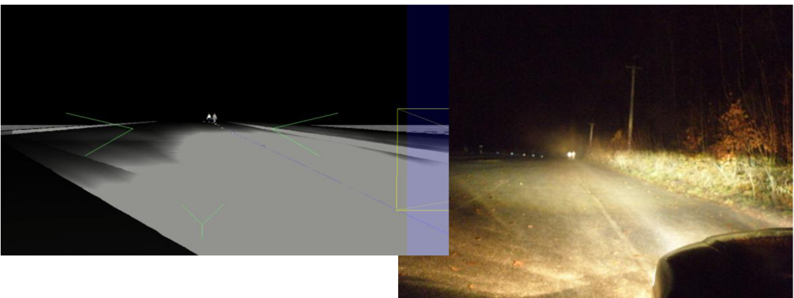
Obrázek 72: Pohled na figuranty v bílém a reflexním oblečení (vzdálenost 70m, dálková světla).
