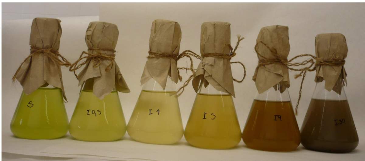
Obr. 16. Barevné srovnání vzorku Scenedesmus subspicatus s přidavkem iontového stříbra (zleva vzorek kontrolní, dále vzorky o koncentraci 0,3 mg/L-30 mg/L).
