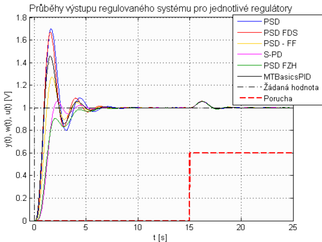
Obr. 8.9: Průběhy výstupu reálné soustavy č. 2 pro hodnoty parametrů jednotlivých regulátorů uvedených v Tab. 8.5
