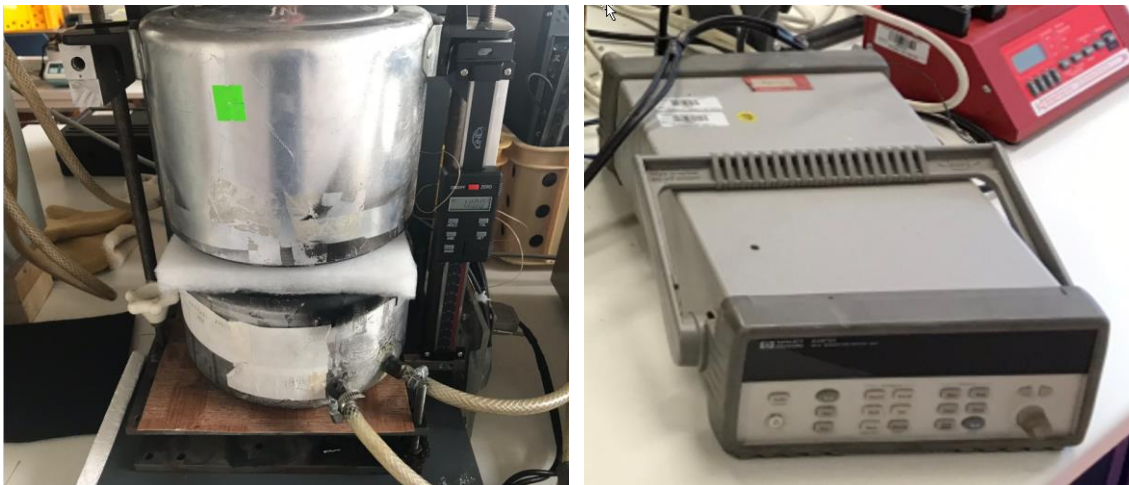
Obrázek 34: A) Tlakové nádoby laboratorní aparatury pro měření tepelné vodivosti objemných materiálů; B) Měřicí přístroj HP kanálový multiplexor Agilent 34901A
