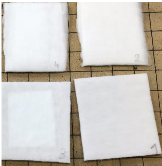
Obrázek 35: Vzorky připravené pro první měření čtverec 20 \times 20 \text{ cm} , tloušťky 11 \text{ mm} .
