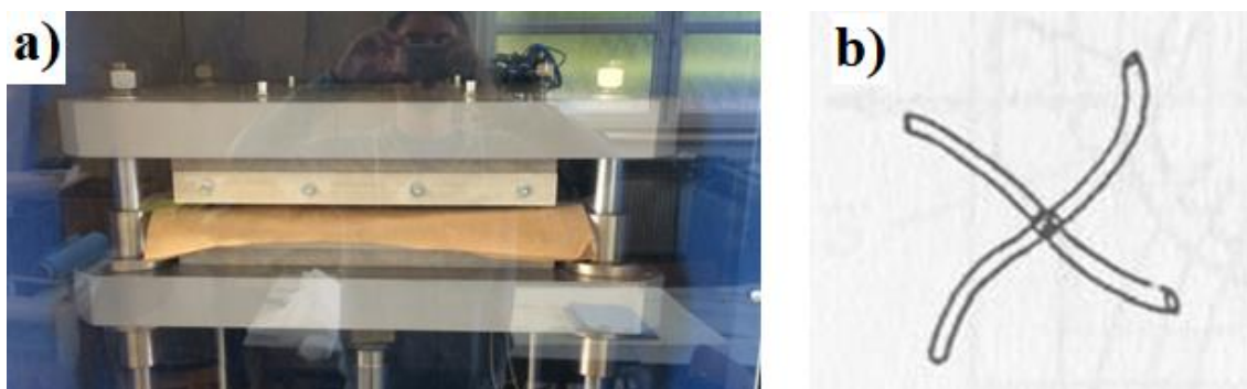
Obrázek 33: a) Pojení vzorků pomocí tepelného lisu; b) Pojení netkané textilie bodové [18].
