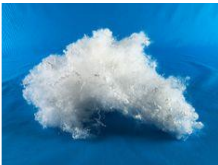
Obrázek 28.: Snímek chomáče základních polyesterových vláken pro výrobu NT
