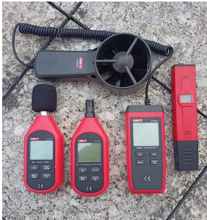
Obrázek 2 Přístroje použité k měření proměnných prostředí (zleva: UNI-T UT 353, UNI-T UT 333, UNI-T UT 363S, pH metr ATC pH-2011).
