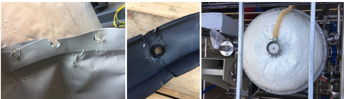
Obr. 95 Poloprovozní AnMBR - identifikace úniků, zkouška plynotěsnosti (foto autor)
