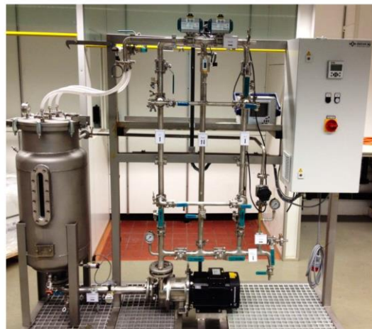
Obr. 26 Poloprovozní side-stream AnMBR pro čištění farmaceutických OV [107]
