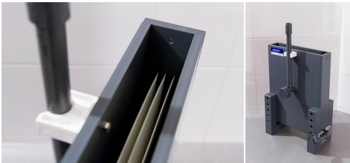
Obr. 44 Membránový modul Microdyn Nadir BIO-CEL LAB BC25x25 (foto autor)
