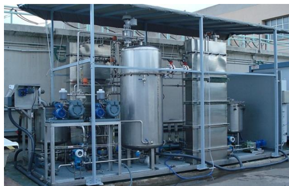
Obr. 25 Pilotní AnMBR s ponornými membránovými moduly tvořenými dutými vlákny (Puron, KMS) [91]
