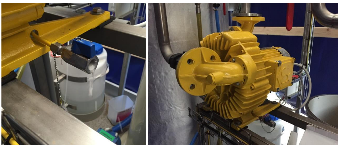
Obr. 89 Poloprovozní AnMBR - kondenzát a čištění dmychadla bioplynu (foto autor)
