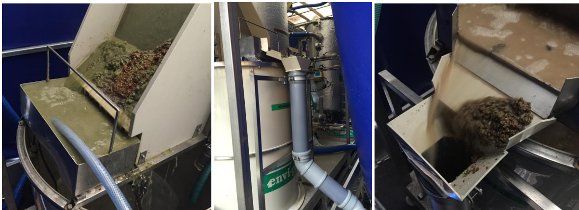
Obr. 73 Poloprovozní AnMBR - zahlcení sběrného koše mechanického předčištění a dobudování přepadu na shrabky (foto autor)
