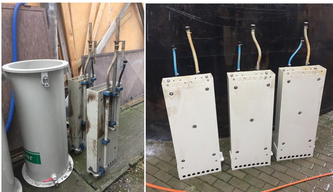
Obr. 101 Poloprovozní AnMBR - přepravní kontejner/nádrž membránových modulů, mechanické čištění (foto autor)
