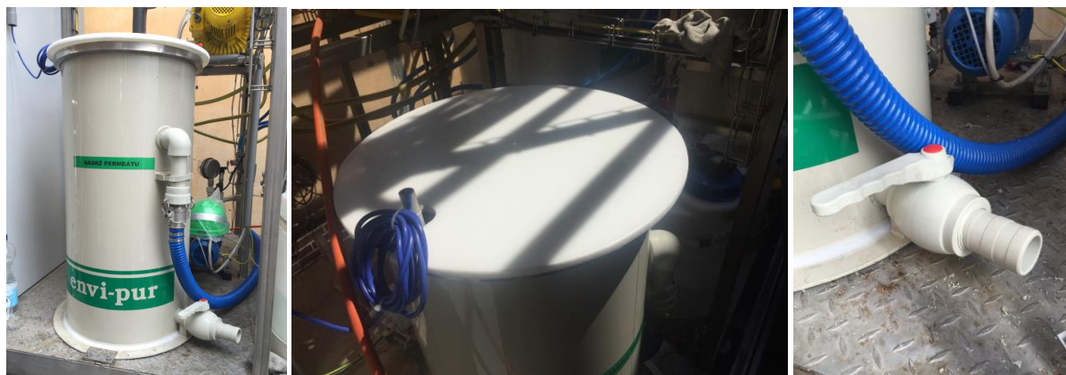
Obr. 87 Poloprovozní AnMBR - nádrž permeátu - poklop a kulový uzávěr / spodní výpust (foto autor)
