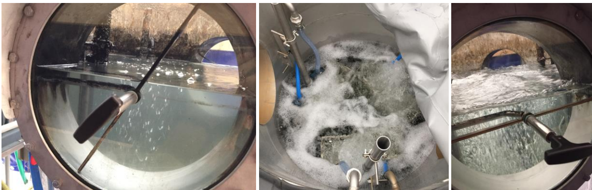
Obr. 85 Poloprovozní AnMBR - kontrola aeračního systému membránových modulů (foto autor)
