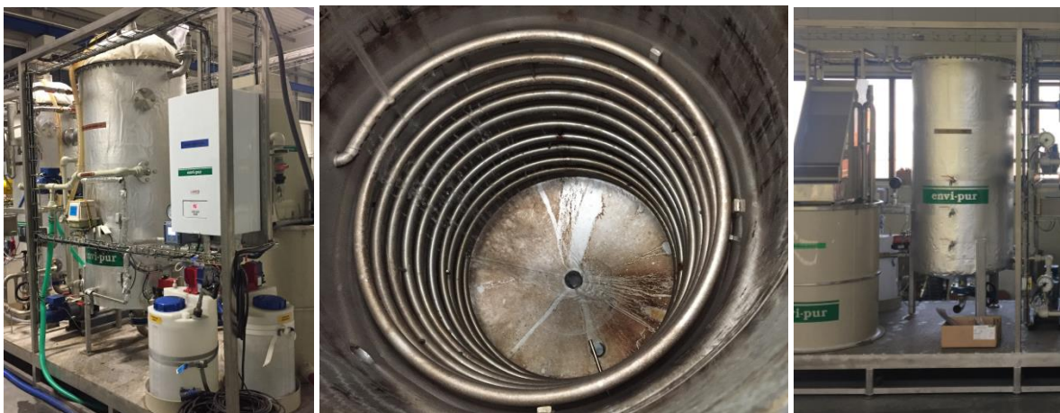
Obr. 57 Poloprovozní AnMBR - anaerobní reaktor, ohřev (foto autor)
