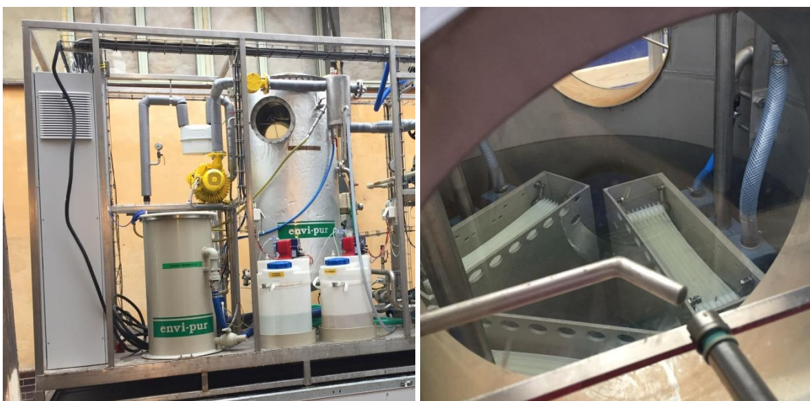
Obr. 60 Poloprovozní AnMBR - membránová komora, membránové moduly (foto autor)
