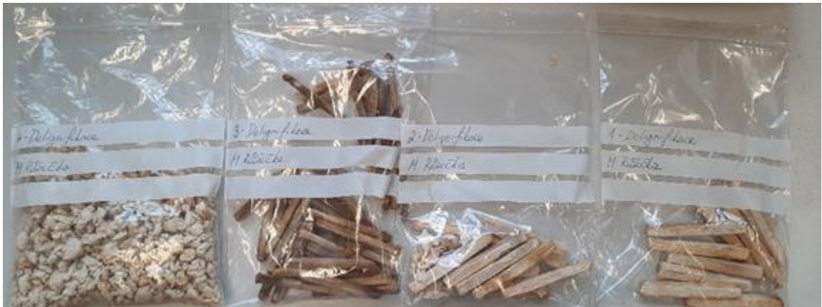
Obrázek 8 Vzorky podrobené různým časům várek (delignifikace)
