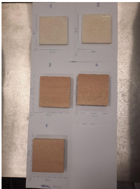
Obrázek 15 Vzorky před testováním na kónickém kalorimetru
