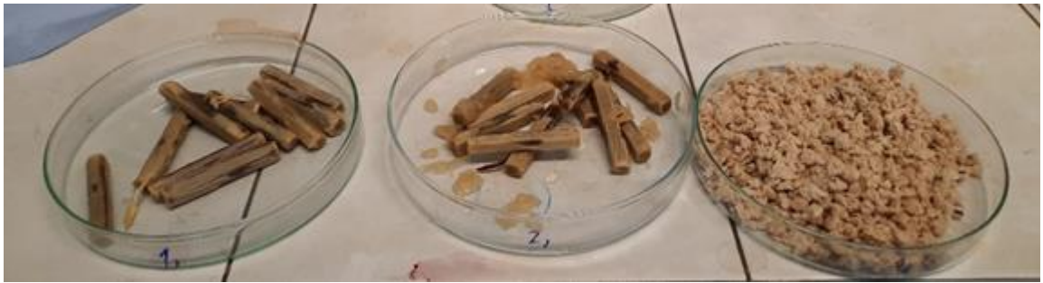
Obrázek 7 Vzorky podrobené různým časům várek (delignifikace)
