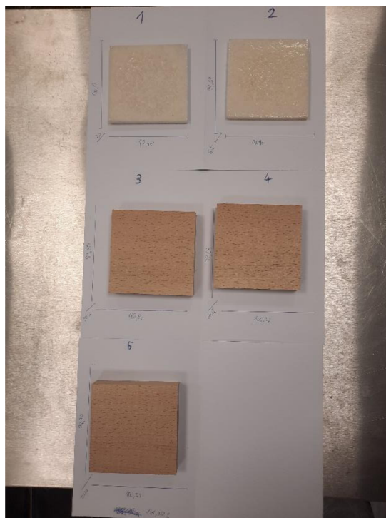
Obrázek 15 Vzorky před testováním na kónickém kalorimetru
