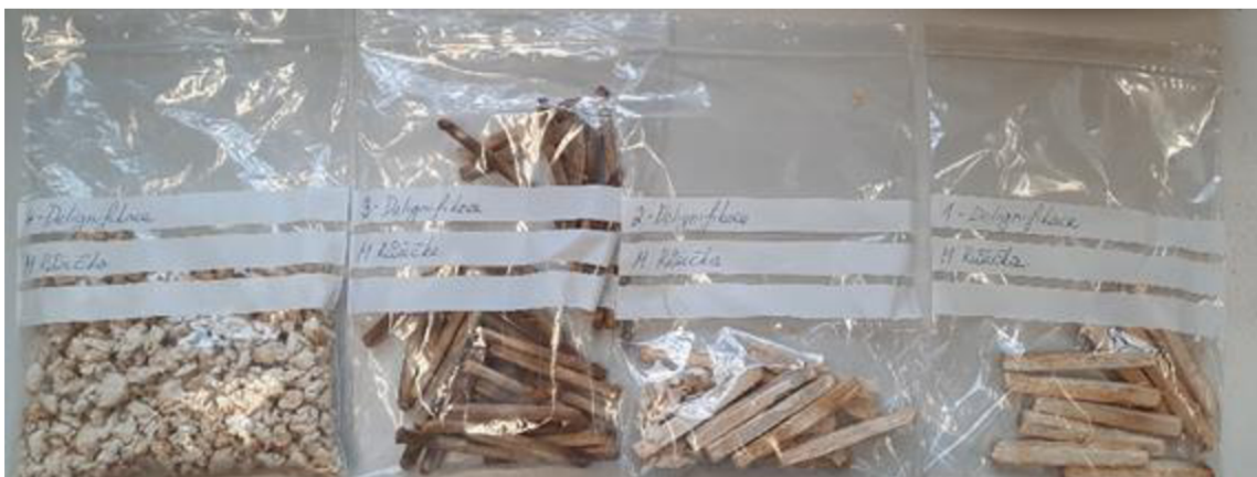
Obrázek 8 Vzorky podrobené různým časům várek (delignifikace)
