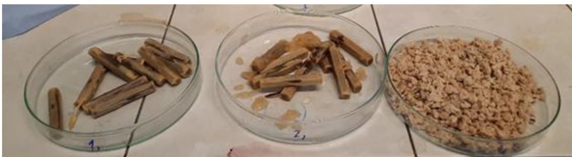
Obrázek 7 Vzorky podrobené různým časům várek (delignifikace)
