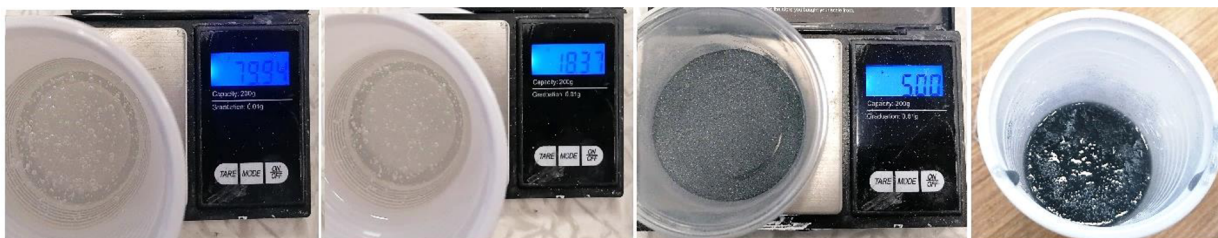
Obrázek 21 Jednotlivé složky matrice, v tomto případě varianty 3. Zleva: pryskyřice LH300 80 g, tužidlo H512 18,4 g, SiC C49 F240 5 g a vpravo výsledná matrice.
