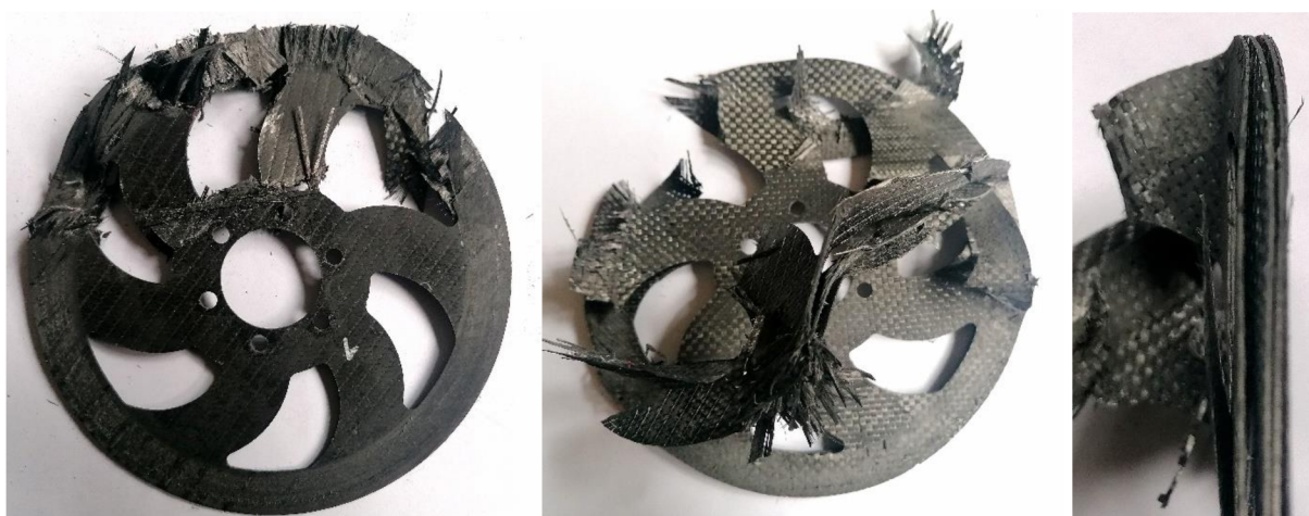
Obrázek 29 Delaminace kotoučů variant 1 a 2
