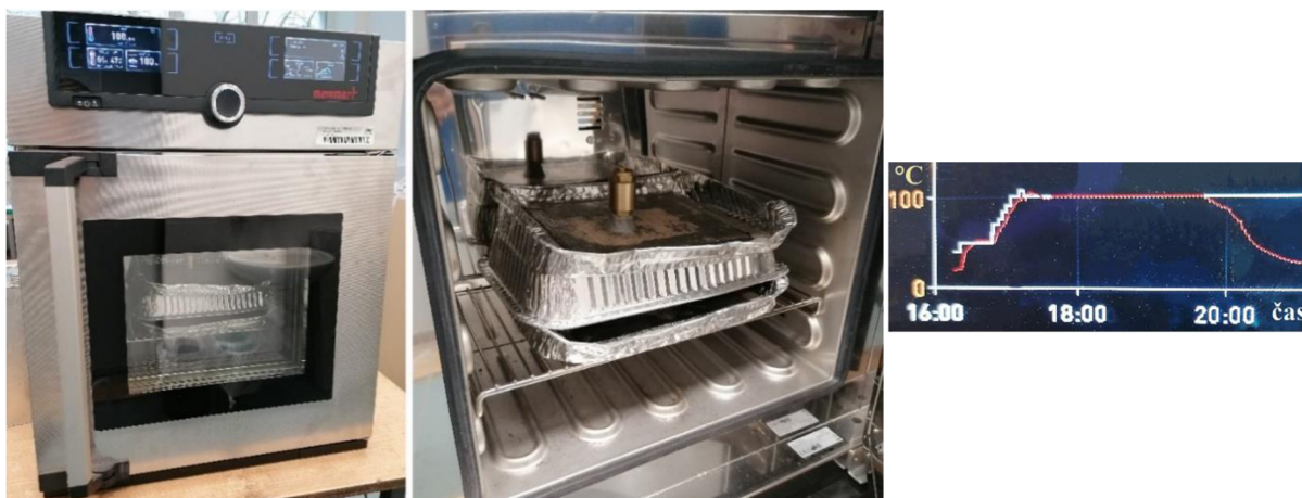
Obrázek 23 Vzorky při temperování v horkovzdušné sušárně a graf průběhu teploty
