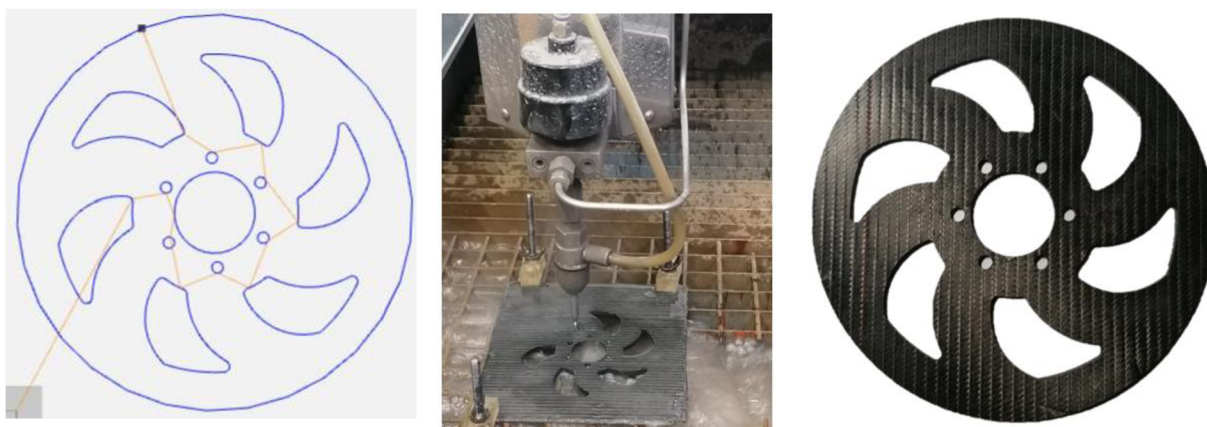
Obrázek 25 Vlevo trajektorie řezu, uprostřed řez vodním paprskem, vpravo finální výrobek brzdového kotouče
