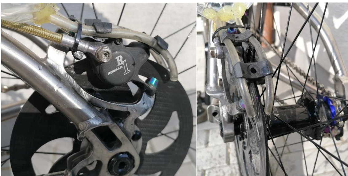
Obrázek 27 Vyrobený skrápěcí vodní systém pro simulaci brždění za mokra podle normy ISO 4210-4
