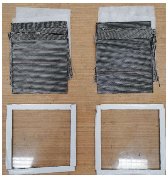
Obrázek 20 Příprava laminace: naseparovaná skla, nalepena vakuovací páska a nařezané tkaniny
