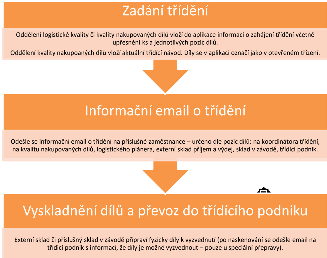
Obrázek 17: Schéma nového návrhu procesu třídění
