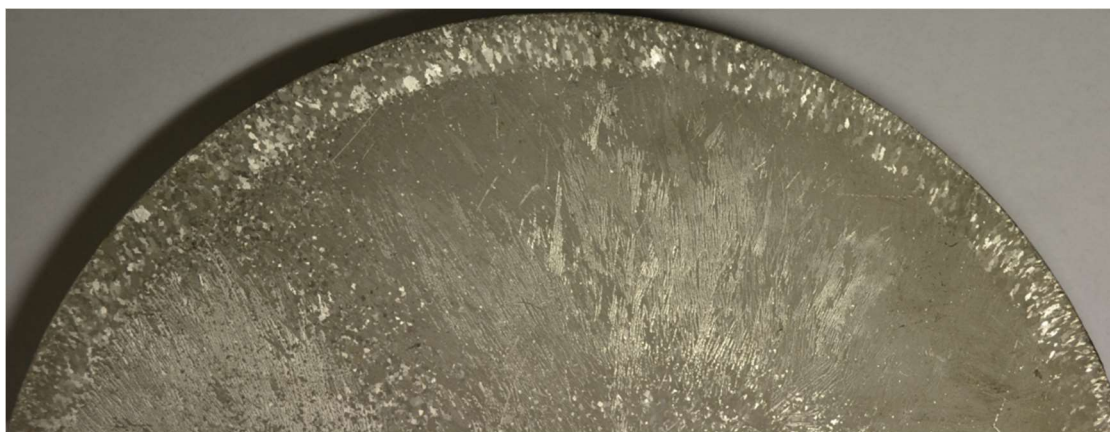
Obr. 178 Výskyt peříčkové struktury po průřezu odlitého čepu – kategorie č.4
