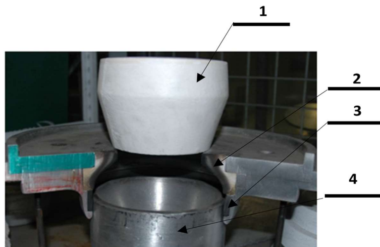
Obr. 12 Hot Top DC licí systém bez přimazávání v řezu; 1 – keramická hlava -Timbel ; 2 – keramický kroužek - Tplate; 3 – grafitový kroužek; 4 – startovací zátk
