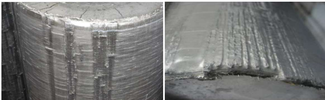
Obr. 20 Podélné rýhy na povrchu čepu
