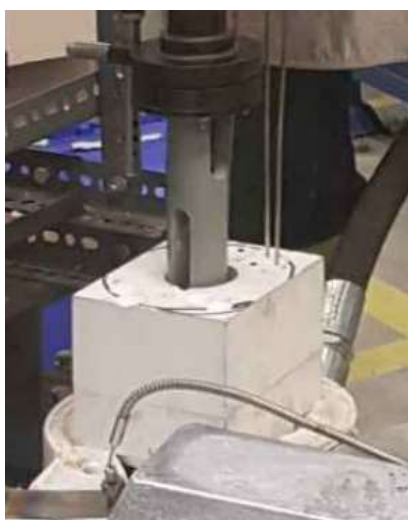
Obr. 192 Umístění čerpadla v „Hot top hlavě“ – 1-čerpadlo, 2-grafit, 3-chladící voda, 4-krytalizační fronta
