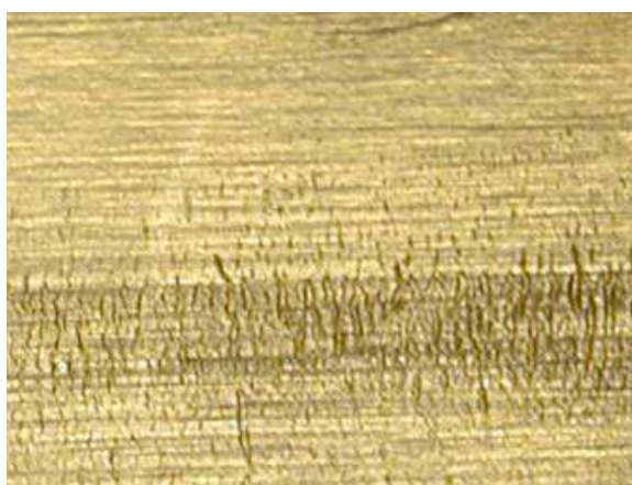
Obr. 51 Typické tepelné trhliny (hot cracks) na povrchu vylisku [72]
