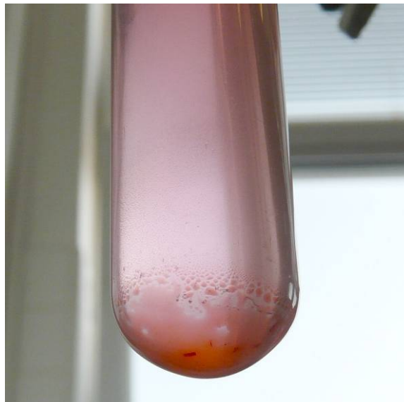
Obr. 32: Vizualizace gelu vzniklého ve vzorku s obsahem 1 mM CTAB/0,1 % hm. AcH1 ve fyziologickém roztoku
