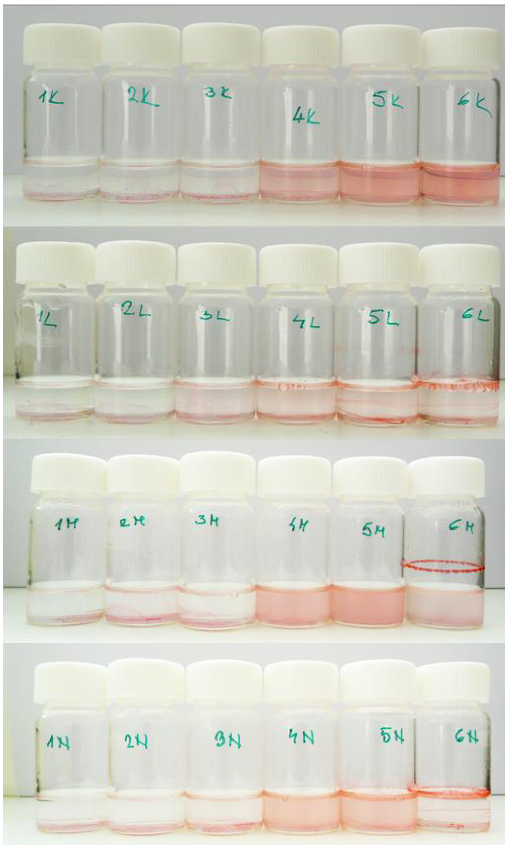
Obr. 30: Fotografie solubilizačních experimentů. Řada K obsahuje pouze tenzid CTAB ve fyziologickém roztoku, řada L obsahuje HyA 90,5 kDa, řada M obsahuje HyA 1,4 MDa a řada N obsahuje hydrofobizovaný derivát AchI.
