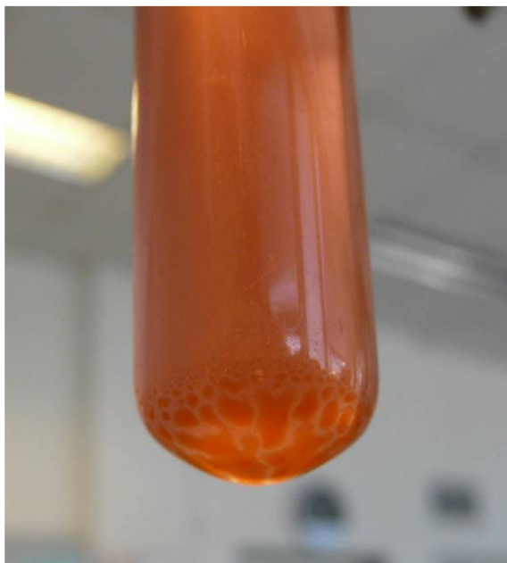
Obr. 33: Vizualizace gelu vzniklého ve vzorku s obsahem 25 mM CTAB/0,1 % hm. AcH1 ve fyziologickém roztoku
