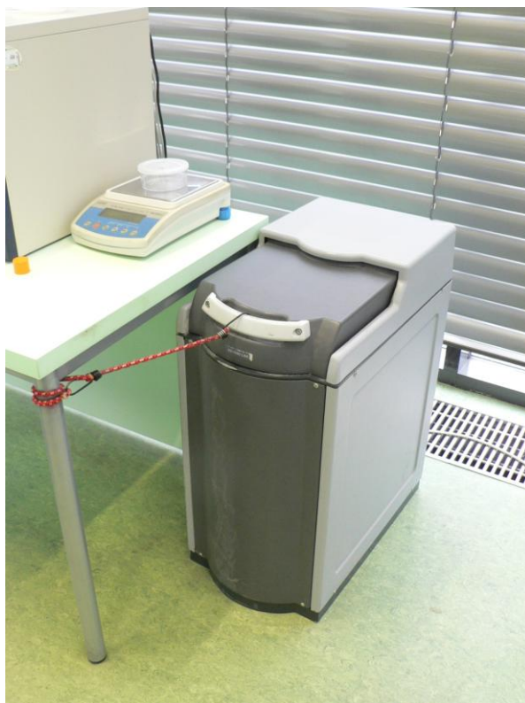
Obr. 3: Zařízení na měření aktivity ^{137}\text{Cs} – gamaspektrometrem SG-1000 LAB s digitálními váhami na nichž je umístěna 250 ml plastová nádoba, v popředí kalibrační tableta (oranžová) (foto Lenka Němčíková)
