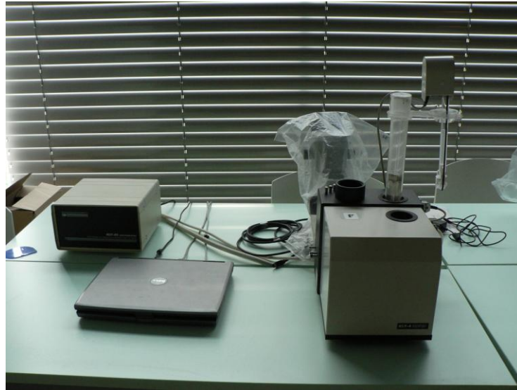
Obr. 1 : Zařízení na měření specifické magnetické susceptibility – kappa můstek KLY-4S (foto Lenka Němčíková)
