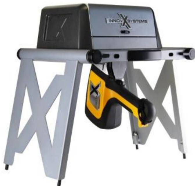
Obr. 5: Zařízení pro stanovení prvkové analýzy – EDXRF spektrometr Innov x systems (www 10)
