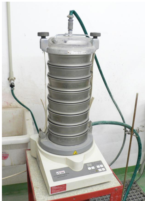
Obr. 2: Pro zjištění zrnitosti vzorků se použilo síťovací zařízení TEST sieve (foto Lenka Němčíková)
