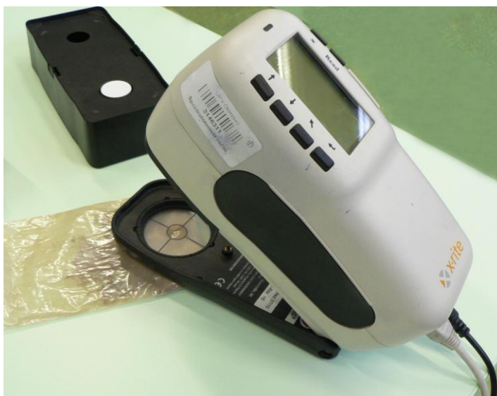
Obr. 4: Zařízení pro měření barvy sedimentu – spektrální fotometr SP-62, v pozadí kalibrační kazeta (se základními barvami – černá, bílá), (foto Lenka Němčíková)
