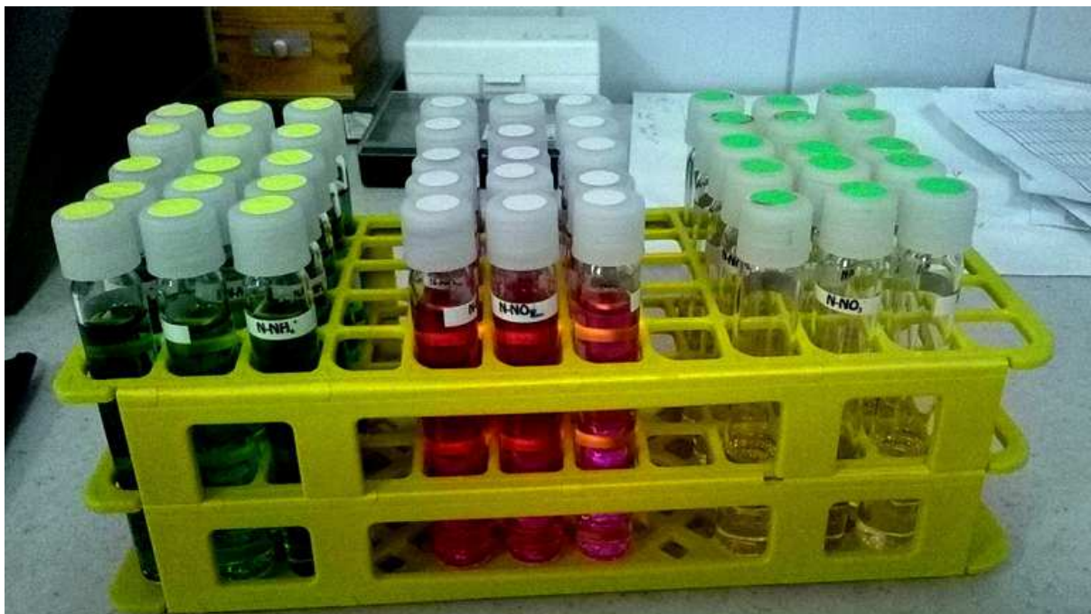
Obrázek 5: Stanovení iontů dusíku, posouzení stálosti výsledných hodnot po vybarvení (Musilová, 2015)
