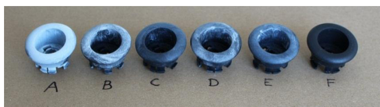
Obrázek 29 Plastové vzorky po lehkém opláchnutí jednotlivých produktů
