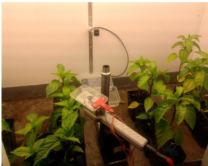
Obrázek č. 5: Měření infračerveným analyzátozem LCA-4 v klimaboxu
