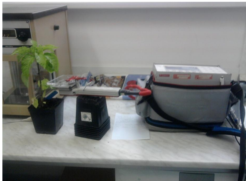
Obrázek č. 7: Měření fyziologických charakteristik papriky roční přístrojem LCA-4
