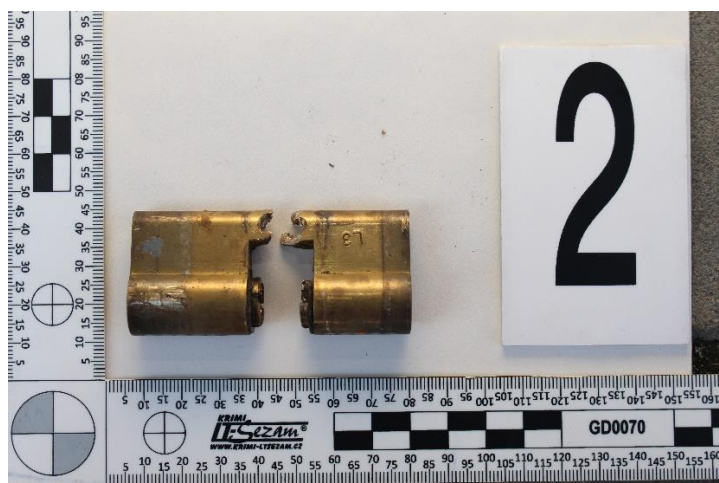
Obrázek 4: Mechanoskopická stopa – cylindrická vložka zámku
