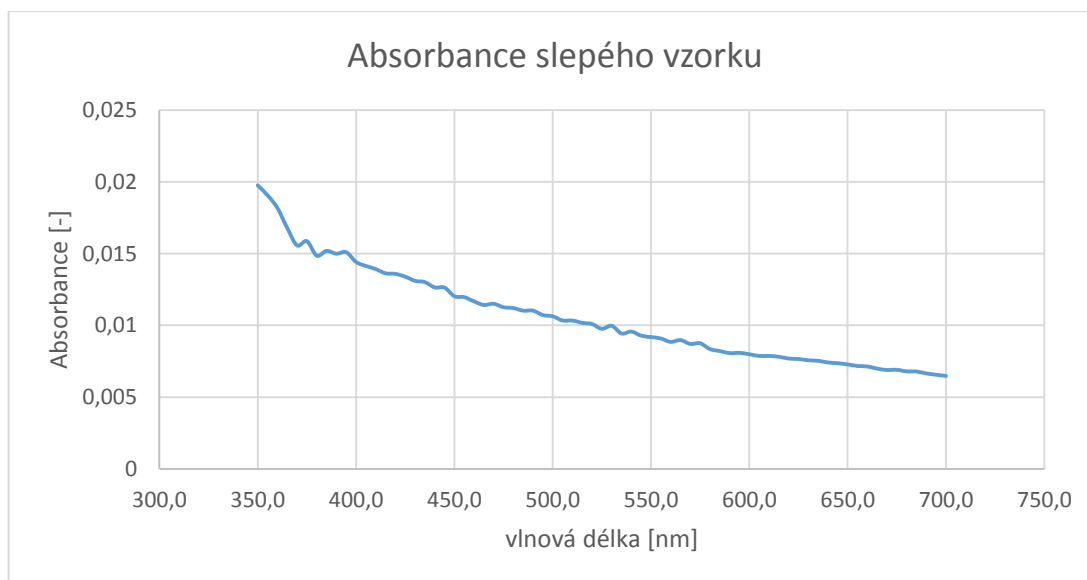
Obrázek 14. Absorbance slepého vzorku pracích vod degradované celulózy
