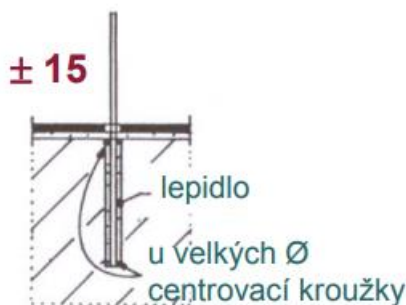
Obr. 19 Lepená kotva do vrtaných děr (chemické kotvy) [20]
