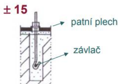
Obr. 18 Dodatečně osazený šrouby do závlače [20]
