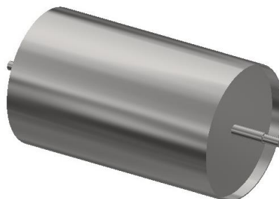
Obr. 48 Svařenec hnaného bubnu a hřídele
