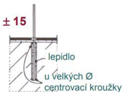
Obr. 19 Lepená kotva do vrtaných děr (chemické kotvy) [20]
