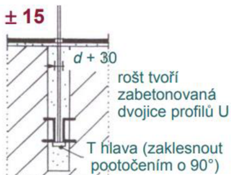
Obr. 23 Dodatečně osazený šroub s T hlavou do roštu [20]
