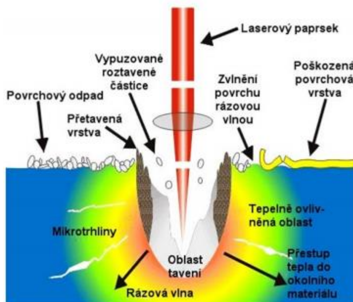
Obr. 2 Schéma řezání laserem
