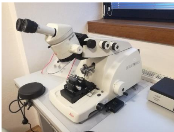
Obr. 8: Ultramikrotom Leica EM UC6 pro krájení pryskyřicových bločků
