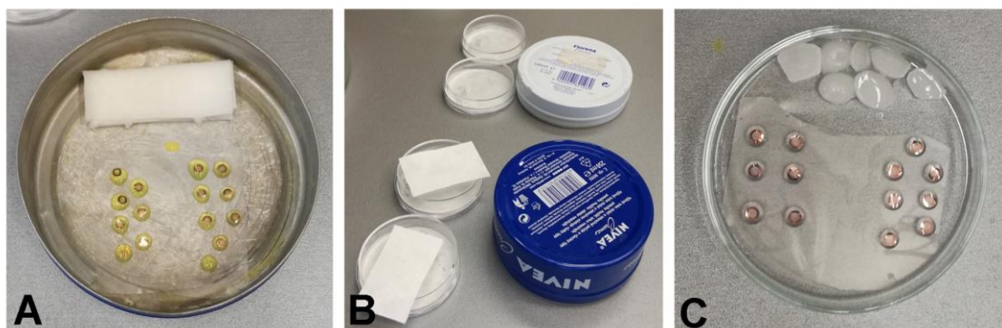
Obr. 17: Záběry z kontrastování ultratenkých řezů. (A) Kapky uranyl acetátu se síťkami na parafilmu v etanolové atmosféře, (B) probíhající kontrastování v krabičkách, (C) kapky citrátu olova se síťkami na parafilmu v atmosféře se sníženým obsahem \text{CO}_2 .
