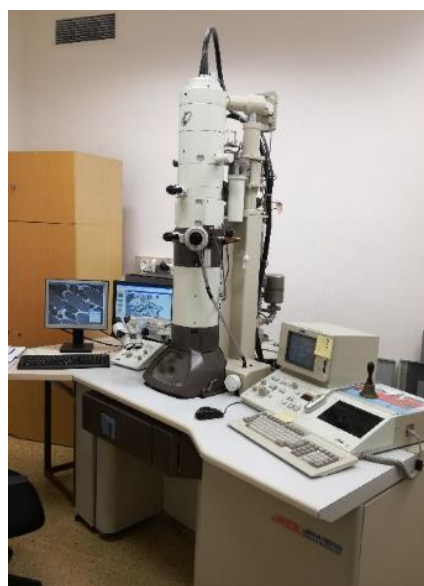
Obr. 7: Transmisní elektronový mikroskop JEOL JEM-1010
