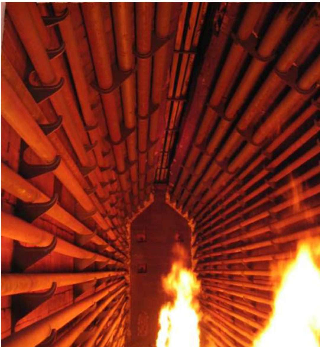
Obrázek 1.4 Pohled do radiační části šachtové pece, zdroj: archiv fy KOČKA INŽEN. TECH. SRO
