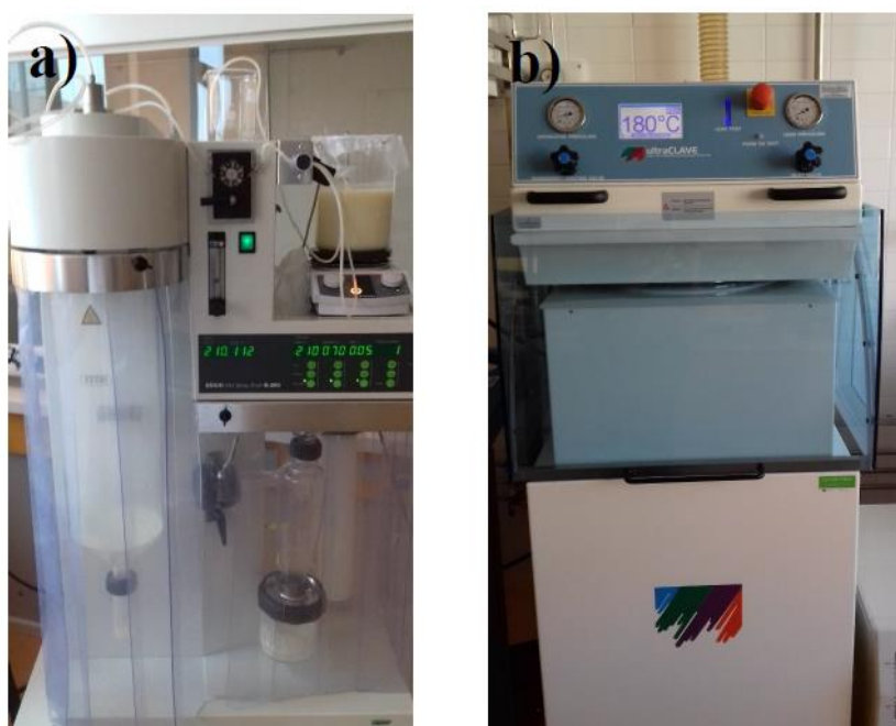
Obr. 25 a) Sprejová sušárna (Büchi Mini Spray Dryer, B-290, Švýcarsko), b) hydrotermální reaktor (Milestone, UltraClave IV, Italy).
