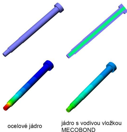
Obr. 2-12 Vliv vodivé vložky na teplotní pole jádra [23]
