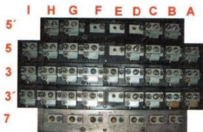
Obr. 3-13 Schéma značení trysek na postřikové hlavě pro pohyblivou část formy
