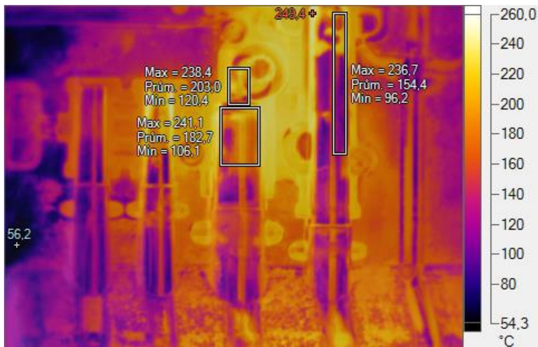
Obr. 3-18 Teplotní pole levé fazony před postřikem při době chlazení 10 s
