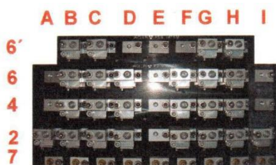
Obr. 3-11 Schéma značení trysek na postřikové hlavě pro pevnou část formy
