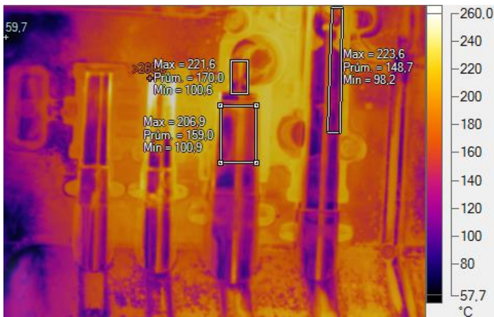
Obr. 3-21 Teplotní pole levé fazony po postřiku při průměrném průtoku 10 \text{ l}\cdot\text{min}^{-1}
