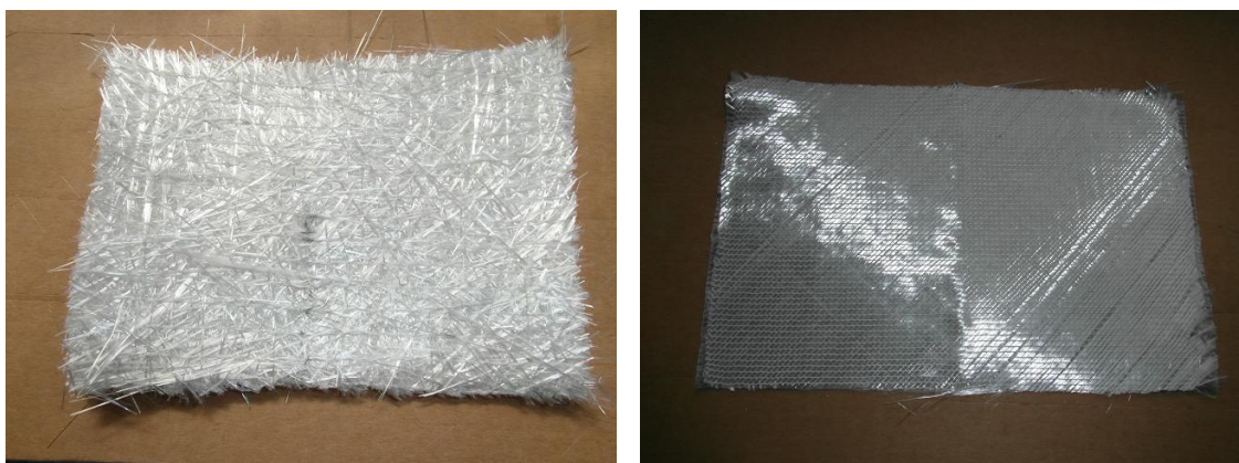
Obr. 9 Typy sklovýztuhy: Rovicore – objemová rohož (vlevo), triaxiální tkanina (vpravo).
