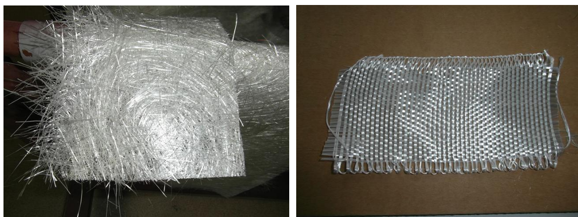
Obr. 8 Typy sklovýztuhy: skelná rohož (vlevo), rovingová tkanina (vpravo).
