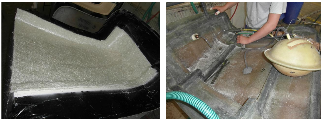
Obr. 13 Lehké RTM – založení sklovýztuže (vlevo), injektážní plnění pryskyřice (vpravo).
