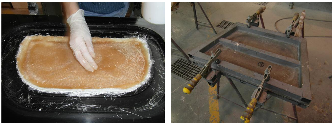
Obr.15 Studené lisování – ruční aplikace pryskyřice (vlevo), mechanické uzavření formy (vpravo).
