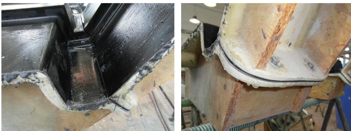
Obr. 11 Dělená forma – pohled z vnitřní (vlevo) a vnější strany formy (vpravo).
