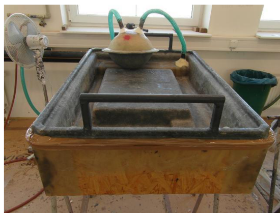
Obr. 14 Lehké RTM – ruční aplikace pryskyřice (vlevo), odsátí vzduchu (vpravo).
