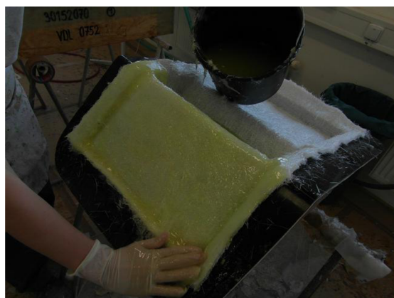
Obr. 14 Lehké RTM – ruční aplikace pryskyřice (vlevo), odsátí vzduchu (vpravo).
