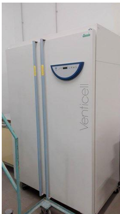
Obr. . 3 Sušárna Venticell (ARCHIV AUTORA, 2017)
