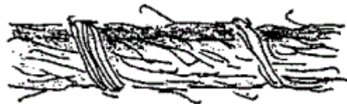
Obr. 6: Rotorová příze s charakteristickými "ovinky" [10]
