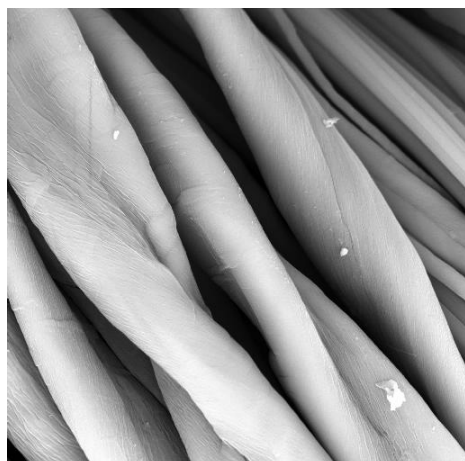
Obrázek 5.32: Tkanina po deposici vrstvy v podélném pohledu – 2. vrstva
