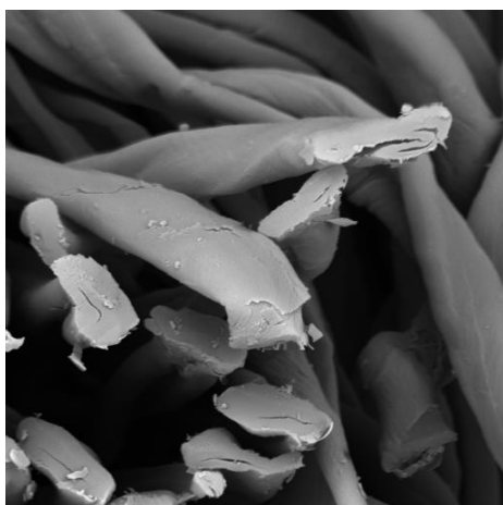
Obrázek 5.28: Tkanina s deponovanou vrstvou v řezu
