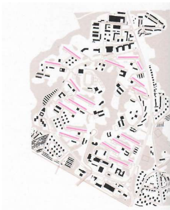
1. Rozmístění devítipodlažních deskových domů
