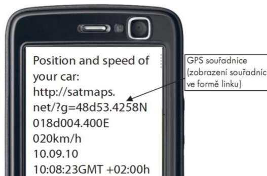
Obrázek 5: Poplašná SMS zpráva systému GPS LOC, která obsahuje odkaz pro zobrazení souřadnice na mapě [23].
