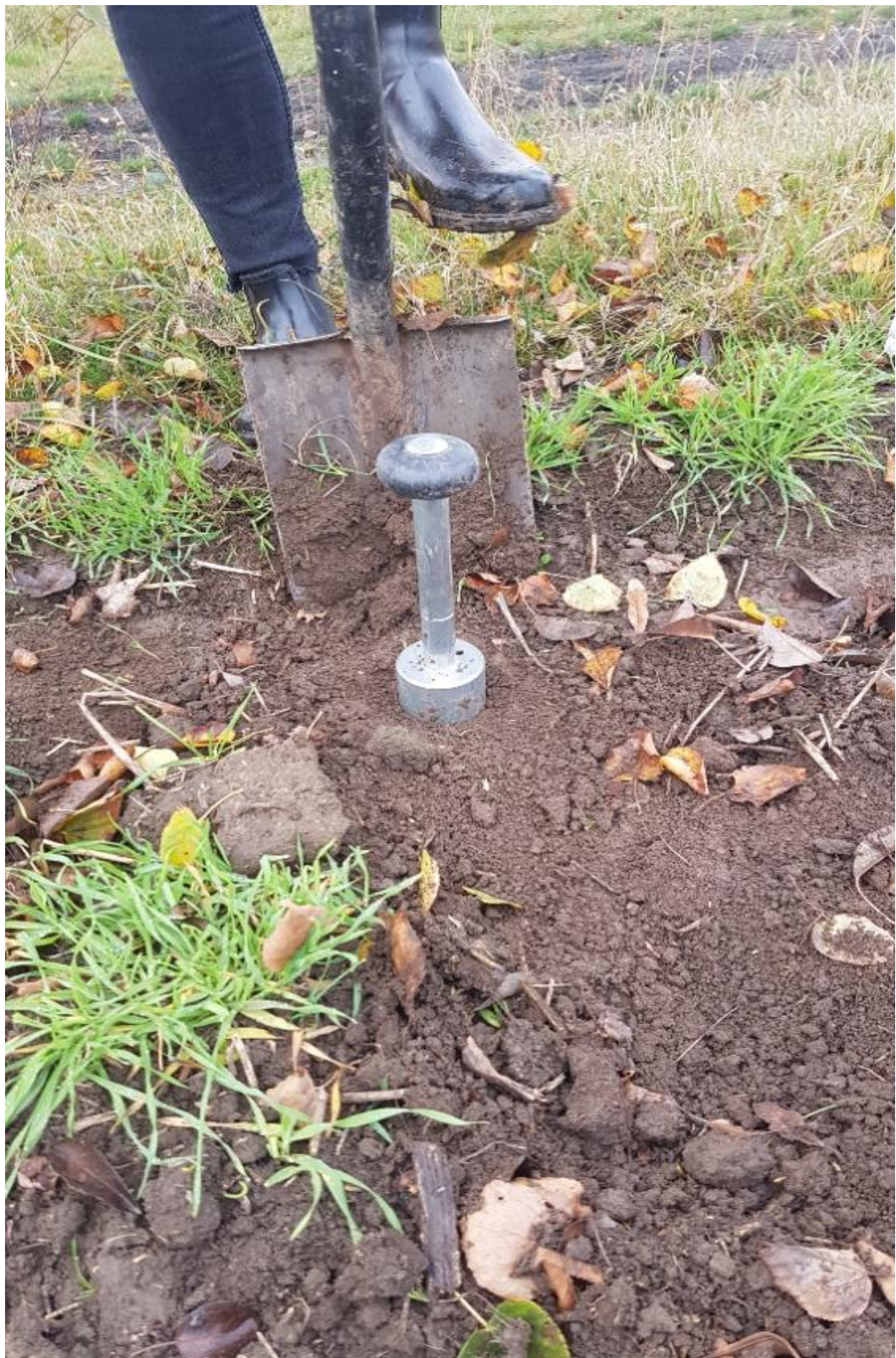
Obrázek 10: Vyjmutí válečku pomocí odběrové hlavy a rýče
