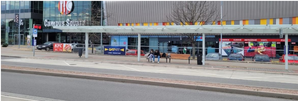
Obrázek 20 - Zastávka v jízdním pruhu s možností objíždění (Nemocnice Bohunice, Brno) [vlastní]
