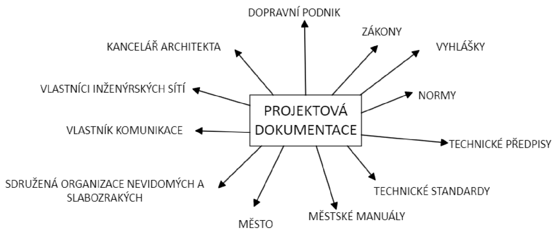
Obrázek 72 - Složky vstupující do procesu projektové dokumentace [vlastní]
