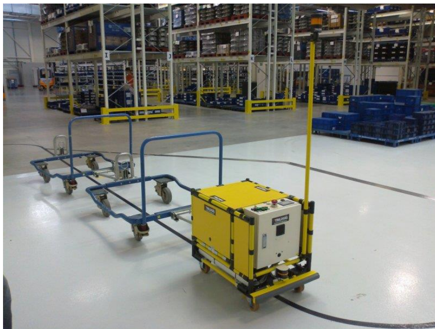
Obrázek 16: Automatické zavážecí zařízení Trilogic
