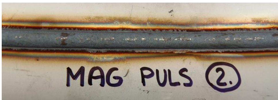
Obr. 30 Fotografie svaru austenitické korozivzdorné ocele metodou MAG
