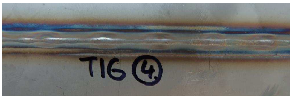
Obr. 33 Fotografie kořene svaru austenitické korozivzdorné ocele metodou TIG
