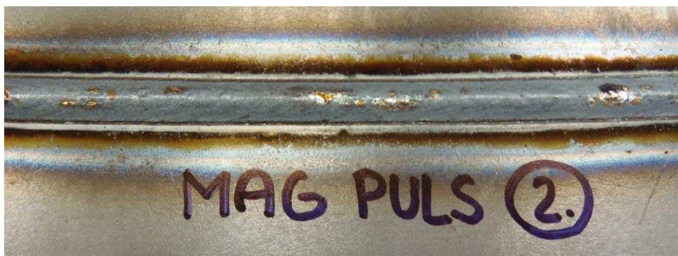
Obr. 36 Fotografie svaru nízkouhlíkové ocele metodou MAG
