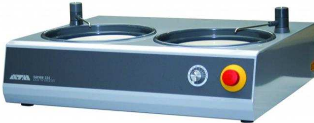
Obr. 41 Brousící zařízení ATA Saphir 330 [25]
