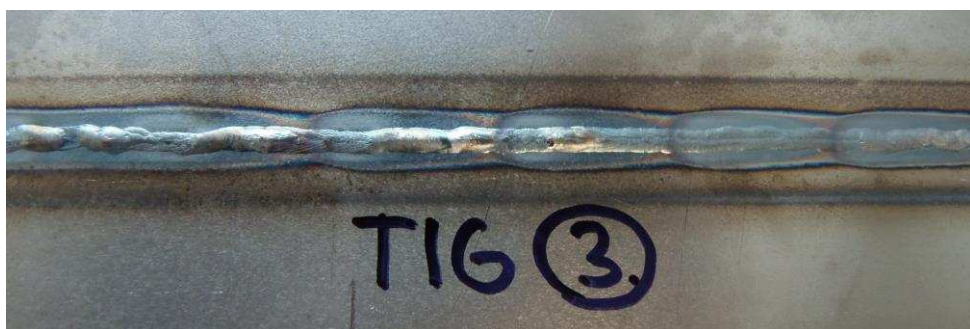
Obr. 39 Fotografie kořene svaru nízkouhlíkové ocele metodou TIG
