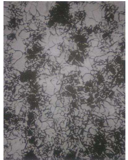
Obr. 4 Struktura „načechraného“ perlitu [14]
