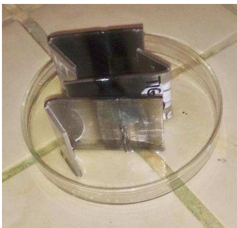
Obr. 42 Leptání vzorků z nízkouhlíkové ocele
