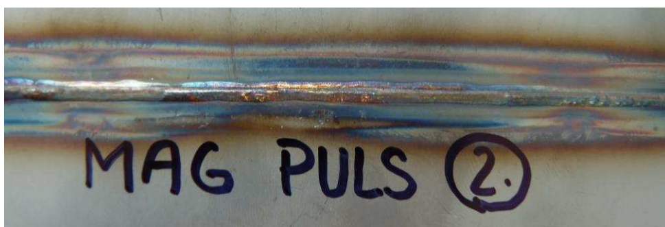
Obr. 31 Fotografie kořene svaru austenitické korozivzdorné ocele metodou MAG
