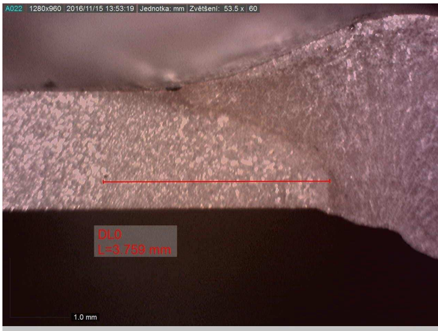
Obr. 52 Makroskopický snímek levé části svaru, metoda MAG PULS, vzorek č.2
