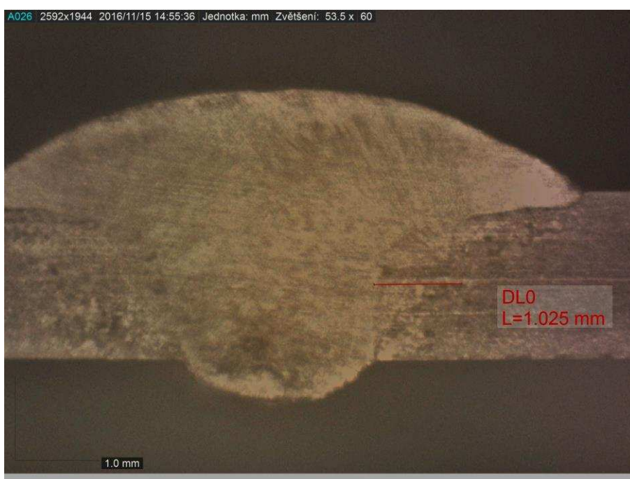
Obr. 47 Makroskopický snímek pravé části svaru, metoda MAG PULS, vzorek č.2
