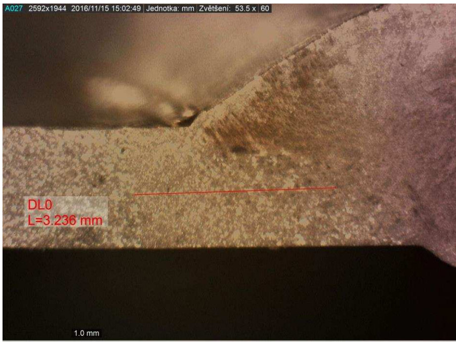
Obr. 50 Makroskopický snímek levé části svaru, metoda CMT, vzorek č.1
