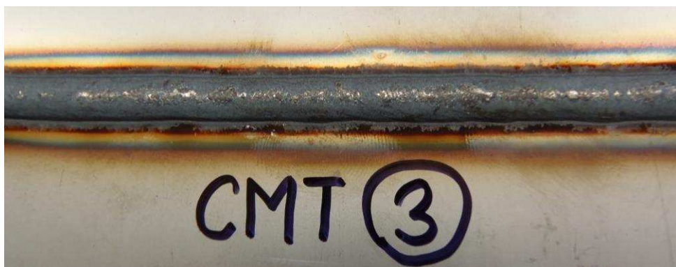
Obr. 28 Fotografie svaru austenitické korozivzdorné ocele metodou CMT
