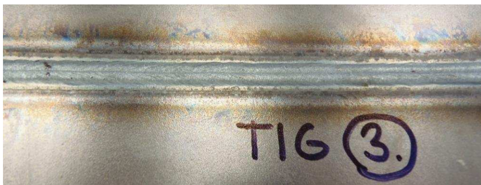
Obr. 38 Fotografie svaru nízkouhlíkové ocele metodou TIG
