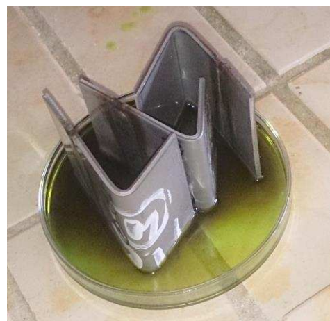
Obr. 43 Leptání vzorků z austenitické korozivzdorné ocele
