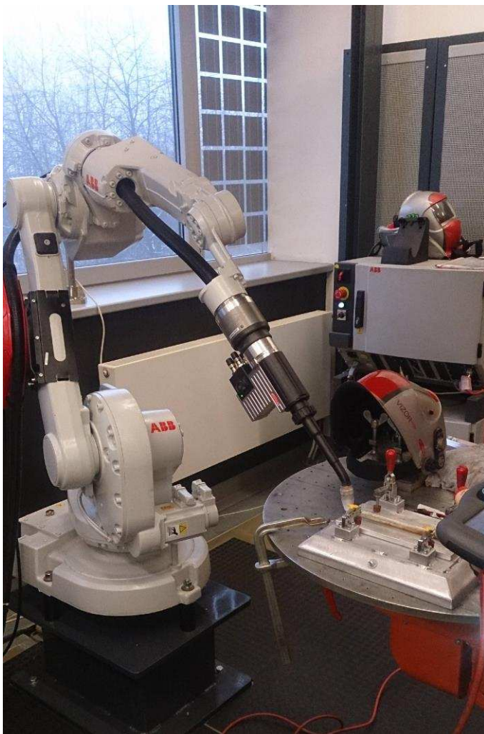
Obr. 27 Svařovací robot ABB IRB 1600c/1.45
