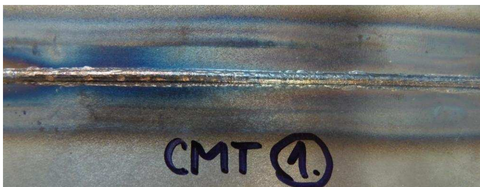
Obr. 35 Fotografie kořene svaru nízkouhlíkové ocele metodou CMT
