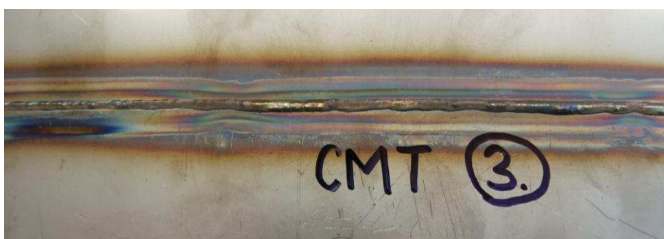
Obr. 29 Fotografie kořene svaru austenitické korozivzdorné ocele metodou CMT
