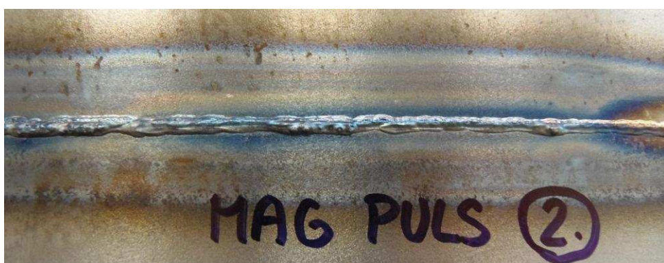
Obr. 37 Fotografie kořene svaru nízkouhlíkové ocele metodou MAG
