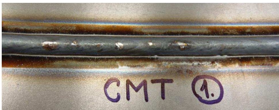
Obr. 34 Fotografie svaru nízkouhlíkové ocele metodou CMT
