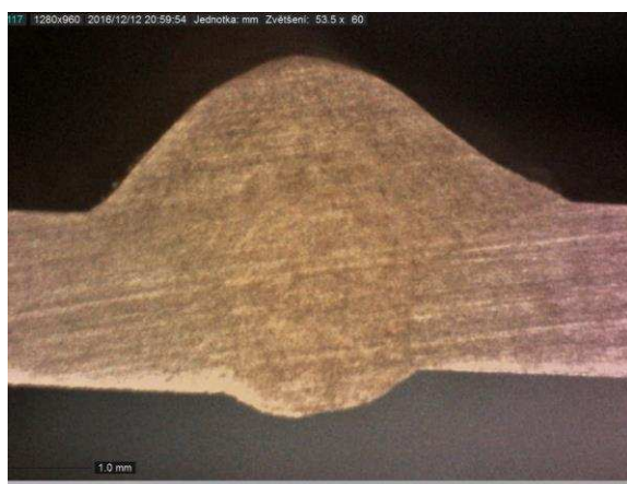
Obr. 57 Makroskopický snímek svaru nízkouhlíkové oceli optimálními parametry metodou CMT
