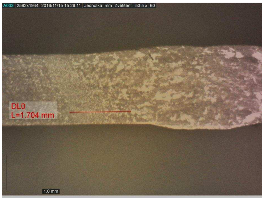
Obr. 54 Makroskopický snímek levé části svaru, metoda TIG, vzorek č.3
