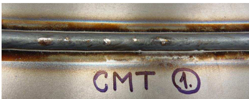
Obr. 34 Fotografie svaru nízkouhlíkové ocele metodou CMT
