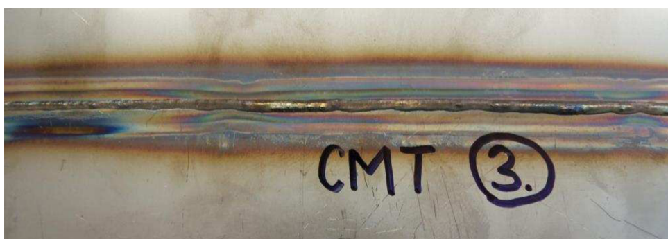
Obr. 29 Fotografie kořene svaru austenitické korozivzdorné ocele metodou CMT
