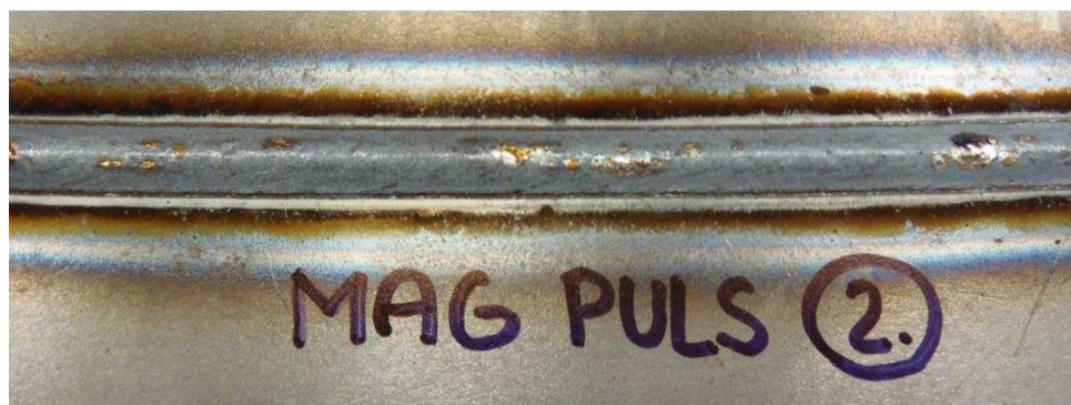
Obr. 36 Fotografie svaru nízkouhlíkové ocele metodou MAG
