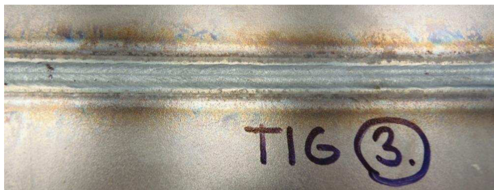
Obr. 38 Fotografie svaru nízkouhlíkové ocele metodou TIG
