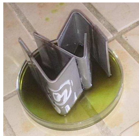
Obr. 43 Leptání vzorků z austenitické korozivzdorné ocele
