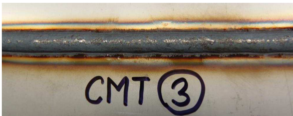
Obr. 28 Fotografie svaru austenitické korozivzdorné ocele metodou CMT
