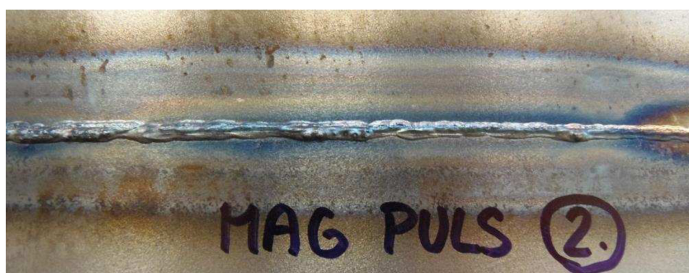
Obr. 37 Fotografie kořene svaru nízkouhlíkové ocele metodou MAG
