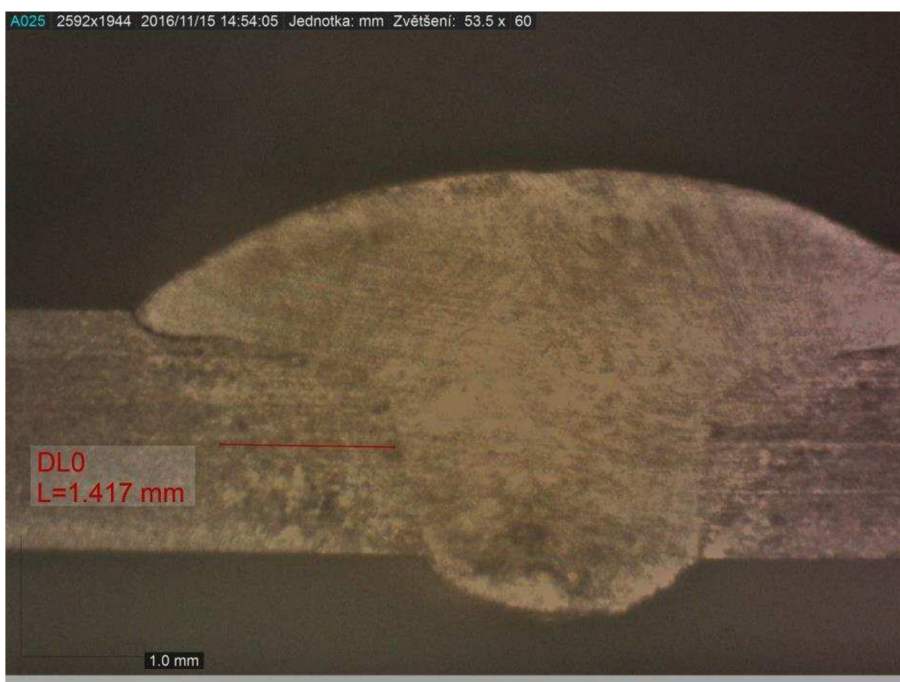
Obr. 46 Makroskopický snímek levé části svaru, metoda MAG PULS, vzorek č.2
