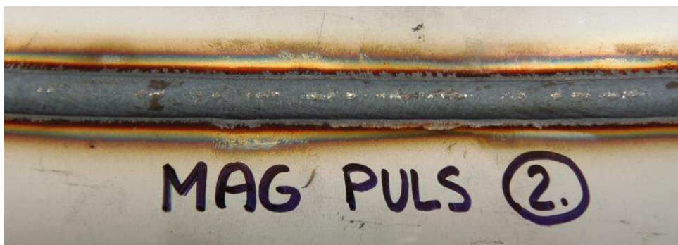
Obr. 30 Fotografie svaru austenitické korozivzdorné ocele metodou MAG
