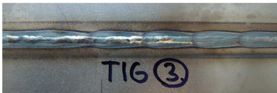
Obr. 39 Fotografie kořene svaru nízkouhlíkové ocele metodou TIG
