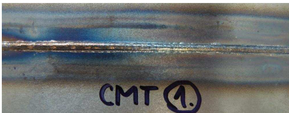
Obr. 35 Fotografie kořene svaru nízkouhlíkové ocele metodou CMT
