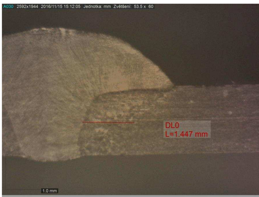
Obr. 45 Makroskopický snímek pravé části svaru, metoda CMT, vzorek č.3
