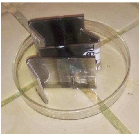
Obr. 42 Leptání vzorků z nízkouhlíkové ocele
